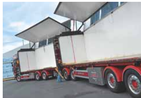
Die weiten Bordwände gewährleisten eine komfortables Be- und Entladen.
