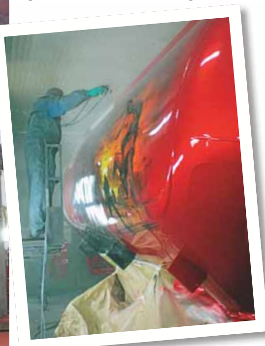
Die aufwendigen Kunstwerke werden zum Schluss mit Klarlack versiegelt.
