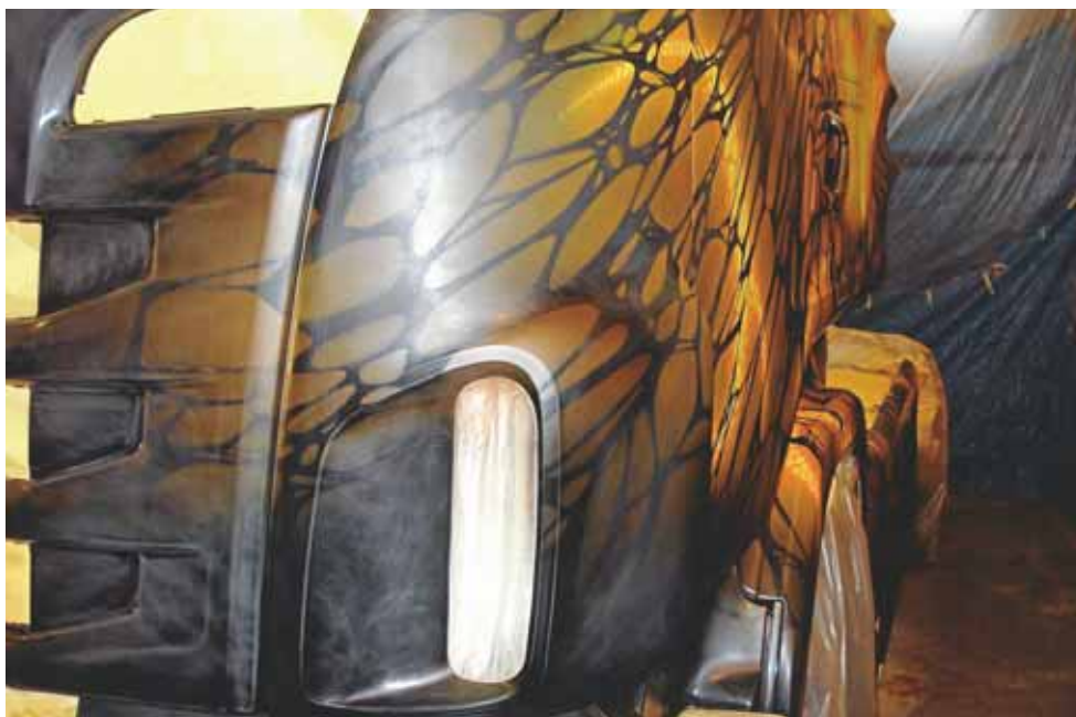
Der gelbe Unterlack verschwindet später unter roter Farbe.
