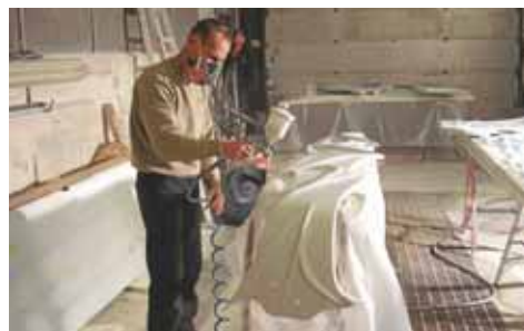
Vor der finalen Lackierung musste die fertige Sonnenblende grundiert werden.
