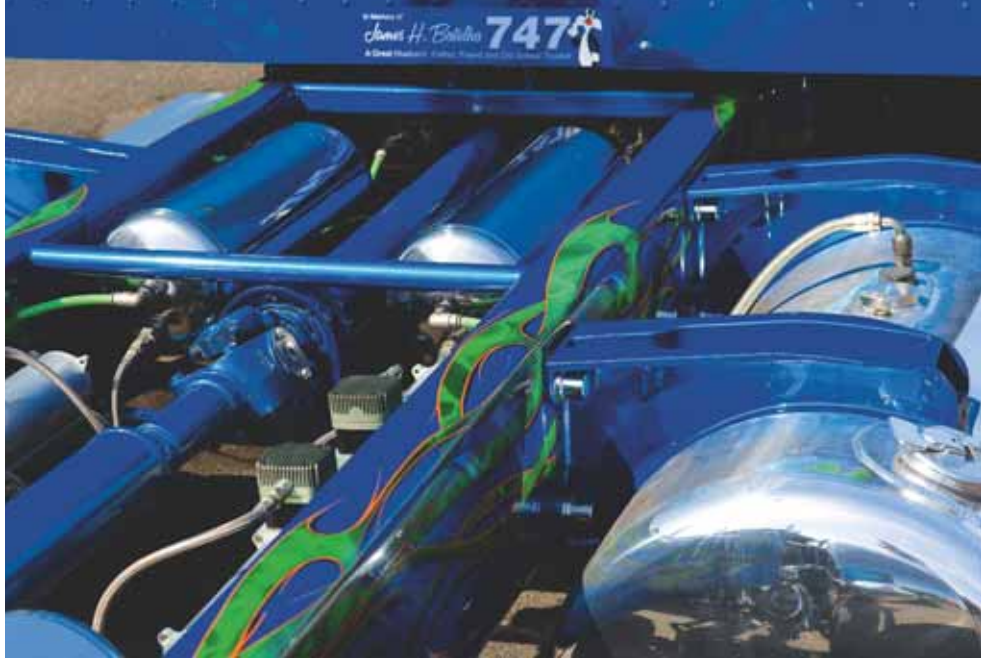
Vier zusätzliche Kompressoren und Druckzylinder sind im Rahmen verbaut.
