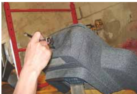
Viele der Bauteile aus Kunststoff lackierte Jani in einer rauen Steinoptik.
