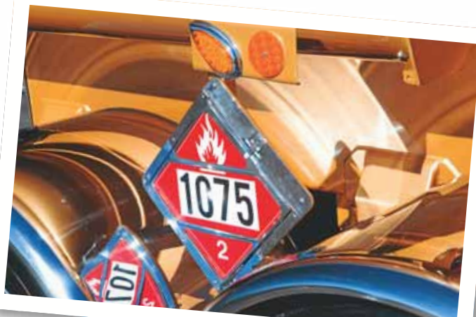
Trotz eines etwas anderen Designs steht die „1075“ auch in den USA für verflüssigte Petroleumgase.
