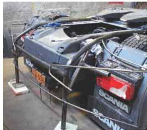
Der Stahlrohrunterbau am Heck ist für die clevere Hebefunktion zuständig.
