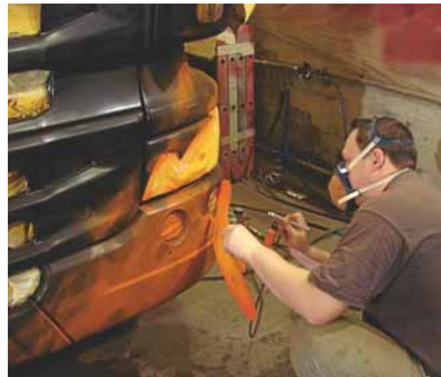
Für die züngelnden Flammen rundum nutzte der Airbruser Schablonen.
