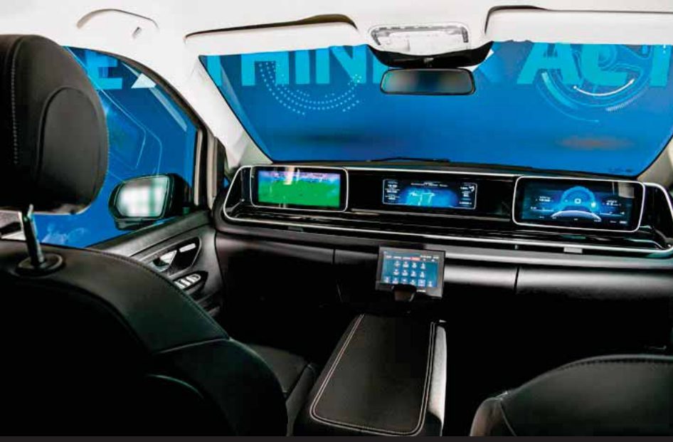
Im Innenraum der automatisierten Fahrzeuge sind weder Lenkrad noch Pedale zu finden. Der Zusteller fährt nicht mehr selbst, sondern nimmt auf der Beifahrerseite Platz. Vorteil: Er muss beim Aussteigen nicht mehr ums Fahrzeug herumlaufen.
