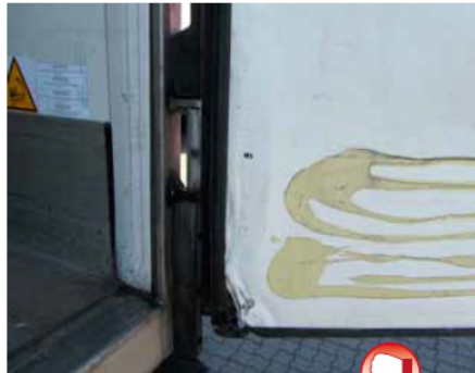
Hecktür Fehlendes Scheuerblech an der Innenseite der Hecktür, beschädigte Türecke
