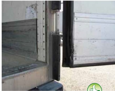
Hecktür Gebrauchsspuren an der Innenseite der Hecktür
