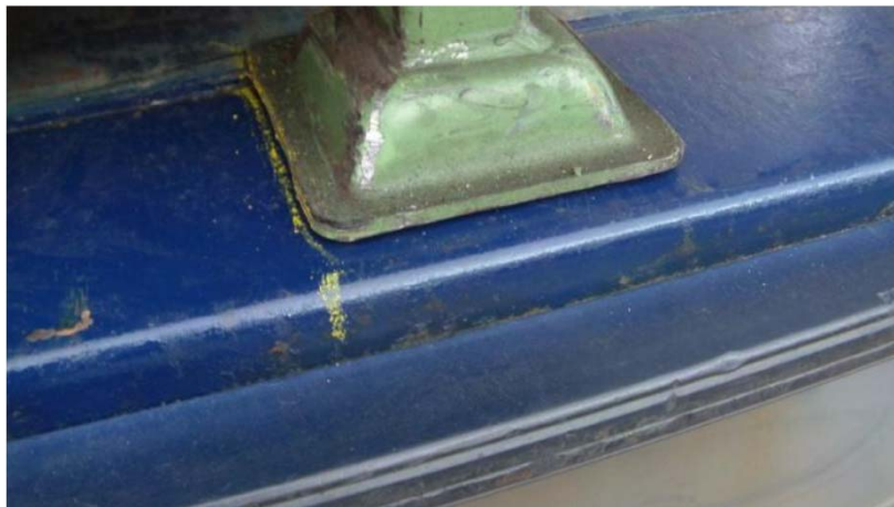
Stand Gitterbox vor Fahrversuch (Man beachte die gemischte Reibpaarung)
