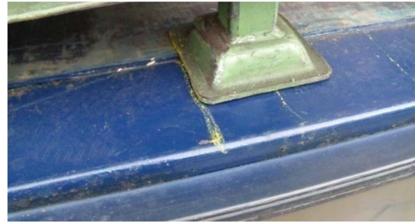
Stand Gitterbox nach dem Versuch, kein Verrutschen erkennbar
