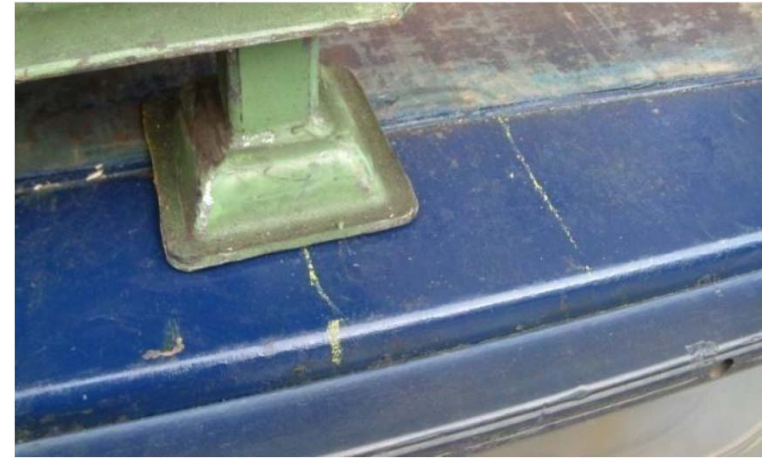
Stand Gitterbox nach Fahrversuch mit kleiner Verschiebung
