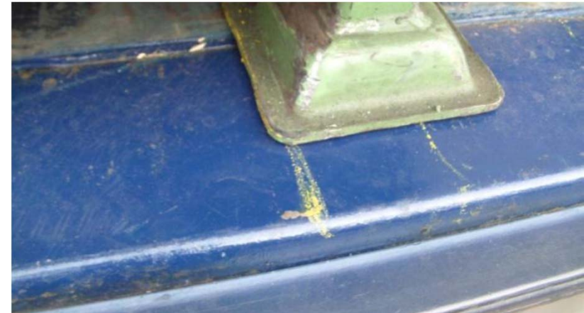
Stand Gitterbox nach dem Versuch, minimale Verschiebung feststellbar
