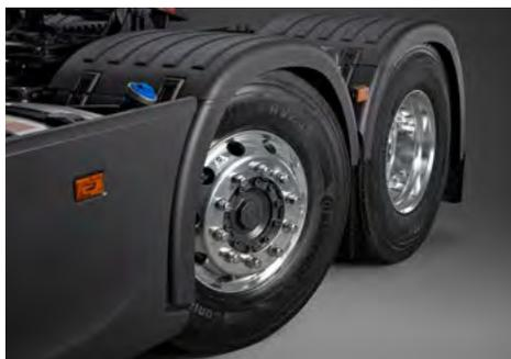
**NEUE ACHSEN IM PROGRAMM:** Neben Vorlauf- gibt's auch eine Nachlaufachse mit einem Lenkwinkel bis zu 19 Grad und 30 Kilogramm weniger Speck.
