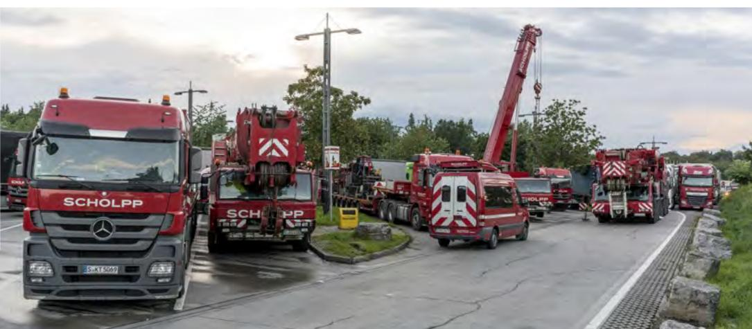
Läppische 130 Tonnen sind ja eigentlich keine besondere Herausforderung für den signalroten Terex AC 500, das dickste Ding im Fuhrpark der Scholpp Kran & Transport GmbH aus Stuttgart. Trotzdem kommt der über 17 Meter lange Achtachser zum Einsatz, als das Scholpp-Team am 18. Juni in Richtung Stuttgarter Kreuz ausrückt, um das erste Segment einer neuen Stahlbrücke über die Autobahn A8 einzuheben.
