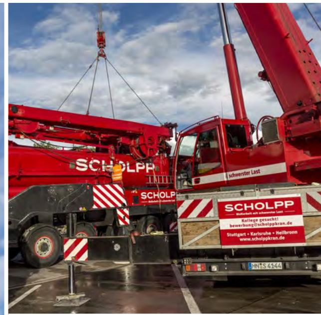
**DER DRITTE KRAN** hebt die sogenannte Abspannung auf den Mast des Terex AC 500. Die komplexe Konstruktion bildet ausgeklappt einen Winkel und erhöht die Tragkraft (o. und l.).
