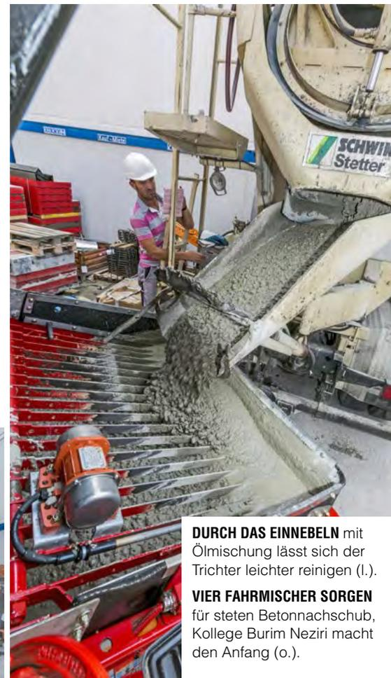
**DURCH DAS EINNEBELN** mit Ölmischung lässt sich der Trichter leichter reinigen (l.).
