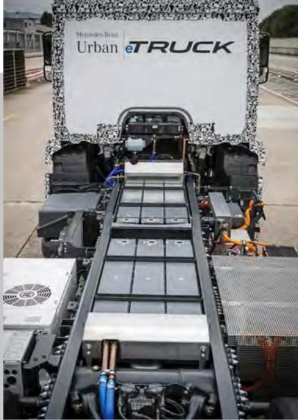
**90 24-VOLT-MODULE SIND AN BORD.** Das Mehrgewicht liegt bei 1.700 Kilo.
