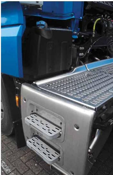
FÜR DEN AUFSTIEG HINTEN gibt es mehrere Varianten, darunter platzsparende Klappstufen.
