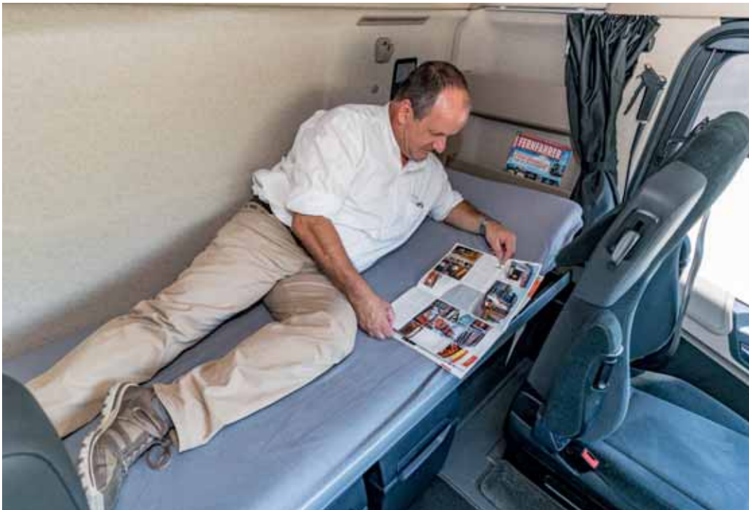
KLARE ANSAGE BEIM UNTEREN BETT: durchgehend 75 Zentimeter Breite und knapp 2,2 Meter Länge.
