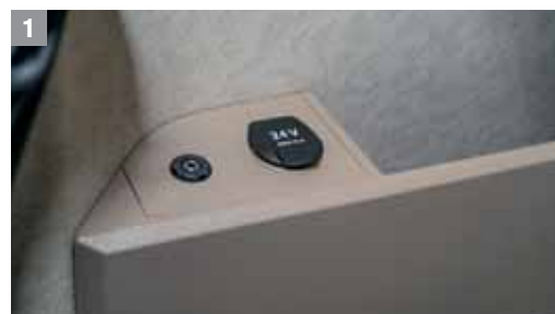
1 IN REICHWEITE DER KOJE, an der Flanke: 24-V-Steckdose und AUX-Anschluss.
