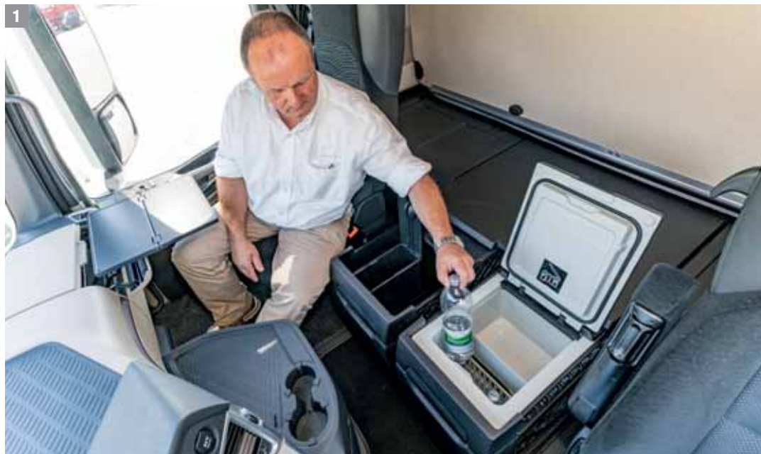
1 UNTER DER LIEGE ist alles sauber abgeschottet. Der Kühlschrank im Schubfach fasst knapp 40 Liter.
