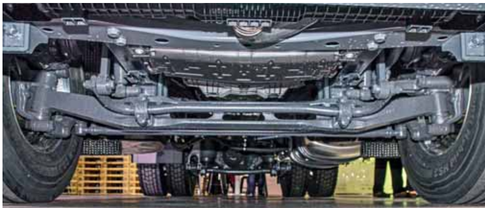
GEWINNT GEGENÜBER DEM AROCS-PENDANT RUND 150 KILO NUTZLAST: Auf Kiesbomber getrimmte Actros-Sattelzugmaschine mit modifizierter Vorderachse für sechs Zentimeter mehr Bodenfreiheit.
