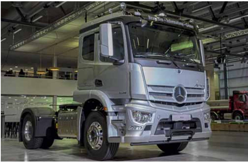
GEWINNT GEGENÜBER DEM AROCS-PENDANT RUND 150 KILO NUTZLAST: Auf Kiesbomber getrimmte Actros-Sattelzugmaschine mit modifizierter Vorderachse für sechs Zentimeter mehr Bodenfreiheit.
