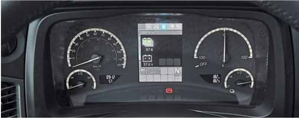
FÜR DEN FAHRER ändert sich vor allem die Anzeige: Geschwindigkeit, Stromverbrauch, Ladezustand.
