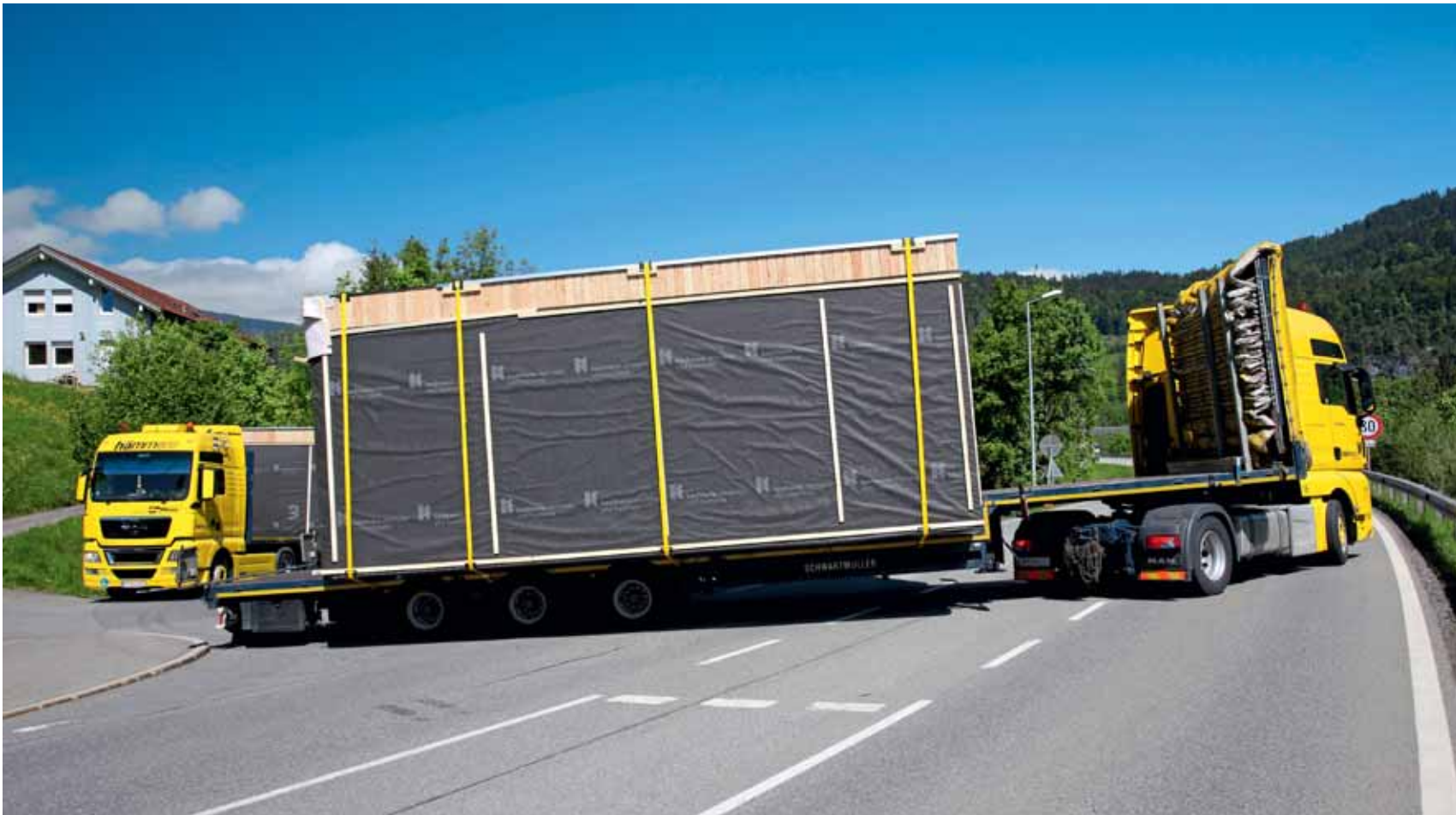
MIT ÜBERBREITE müssen enge Kurven vorsichtig umrundet werden. Die Begleiter und die Fahrer verständigen sich mit wenigen Worten über CB-Funk.
