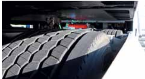
HINTER DEM VORDERRAD tritt die Abluft aus dem Motorraum aus, da der Unterboden komplett verkleidet ist. Außerdem rollt der Truck auf Supersingles. Das reduziert den Rollwiderstand und spart Sprit.
