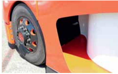
HINTER DEM VORDERRAD tritt die Abluft aus dem Motorraum aus, da der Unterboden komplett verkleidet ist. Außerdem rollt der Truck auf Supersingles. Das reduziert den Rollwiderstand und spart Sprit.
