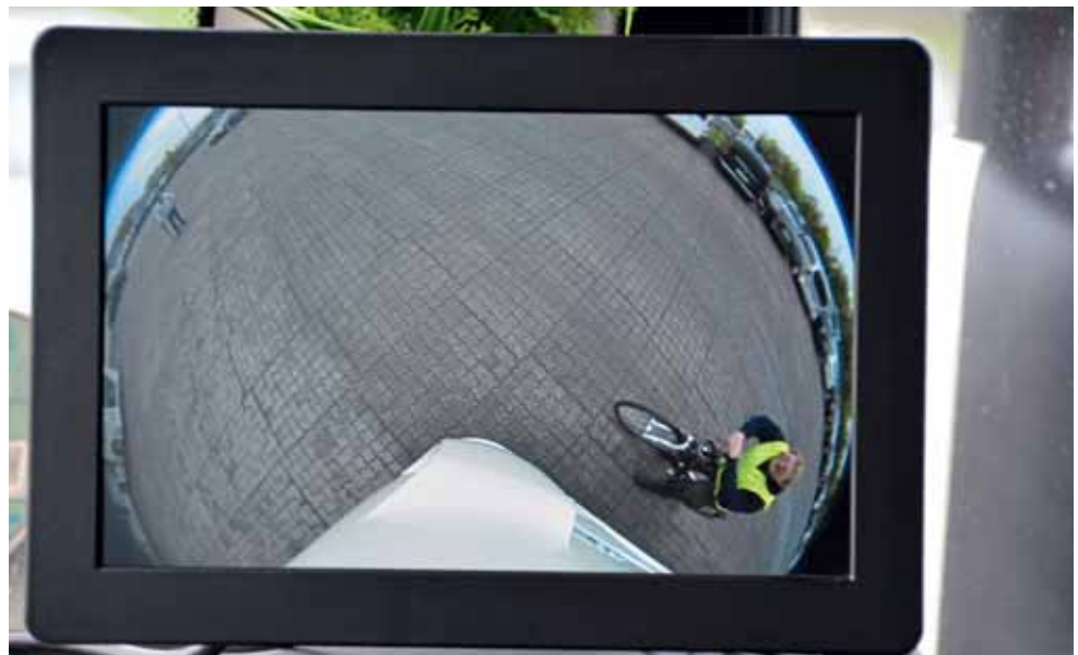
ALLES IM BLICK: Hinter Corner Eye steckt eine HD-Kamera mit 270-Grad-Sicht für tote Winkel am Lkw. Der Bildschirm hängt in der Kabine innen rechts in Blickrichtung der Spiegel.
