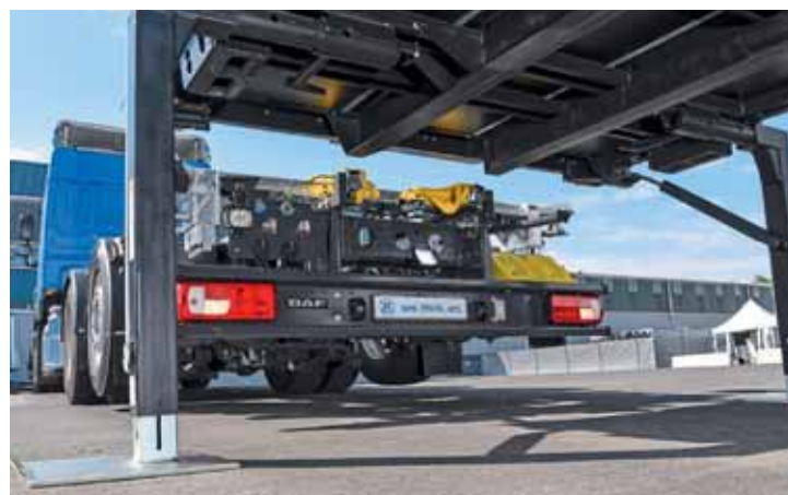
PRÄZISE SETZT DER LKW UNTER DIE BRÜCKE und hebt sie per Luftfeder aus.
