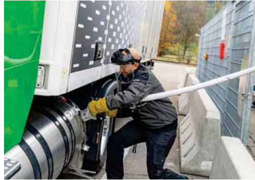
DAS LNG-TANKEN mit Gesichtsschutz und Kältehandschuhen ist anfangs gewöhnungsbedürftig.
