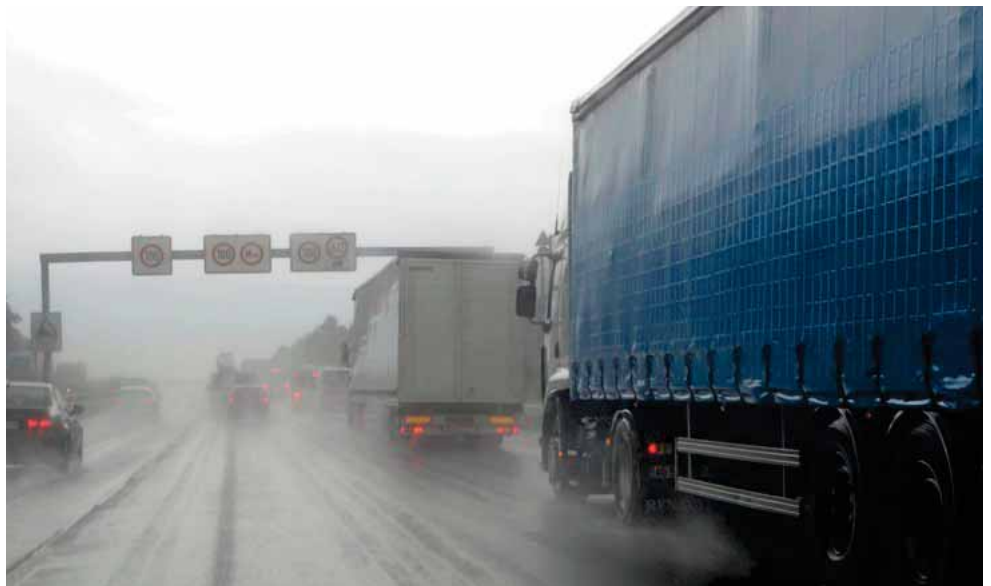
BEI REGEN REAGIEREN die aktuellen Notbremssysteme der Hersteller genauso wie bei trockener Fahrbahn. Nach der Warnphase von 1,4 Sekunden verzögern sie mit 6 m/s 2 deutlich zu stark.
