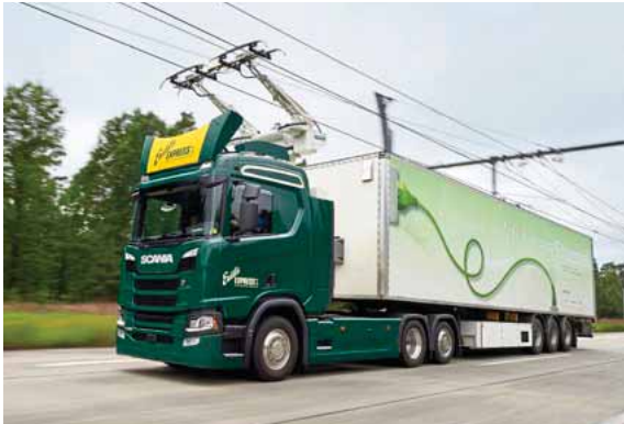
VON SCANIA stammen die Hybrid-O-Lkw. Sie beziehen ihren Strom während der Fahrt über die Oberleitungen.
