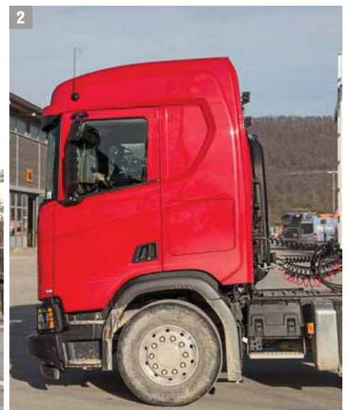
1 DER TRIEBSTRANG ist typisch Straßenroller und optimal für die Autobahn. 2 MIT KNAPP 3,40 METER Gesamthöhe kann das R-Fahrerhaus für den Bau gerade noch als Allrounder gelten.
