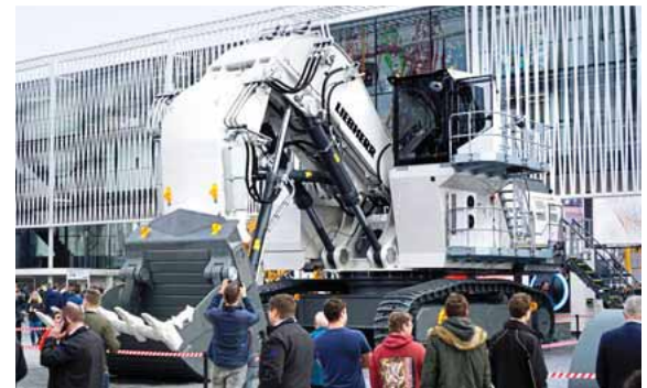
KOMATSU ROLLTE DEN GRÖSSTEN BAGGER ZUR MESSE: Der PC4000-11 (o.) erreicht ein Gewicht von 409 Tonnen. Der 200-Tonnen-Bagger R 9200 E (M.) von Liebherr arbeitet elektrisch und hängt an der „Steckdose“.
