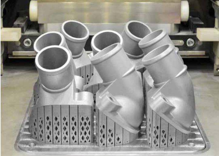
EINMAL GESÄUBERT und von überflüssigem Grundmaterial befreit, zeigen sich die einzelnen gedruckten Ersatzteile.
