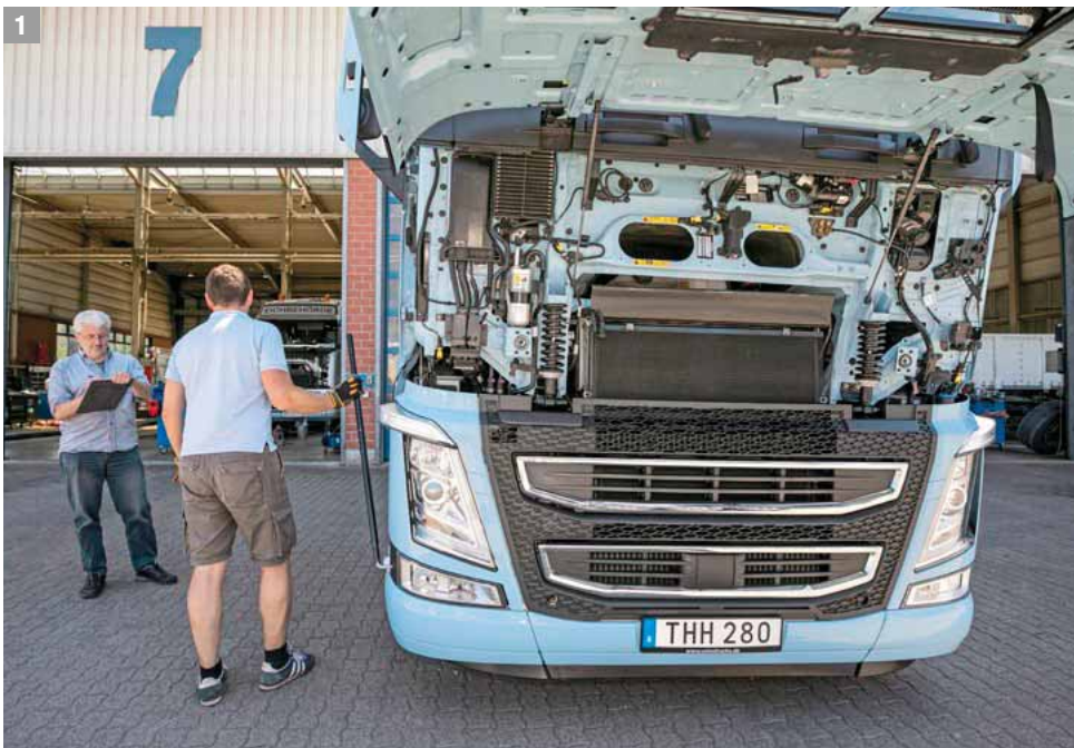
1 DER VERZICHT auf eine Kippelektrik hat nichts mit den LNG-Modellen als solchen zu tun, da wurde am Testwagen schlichtweg gespart. Hinter der Frontklappe bietet sich das von den Diesel-FH gewohnte Bild.
