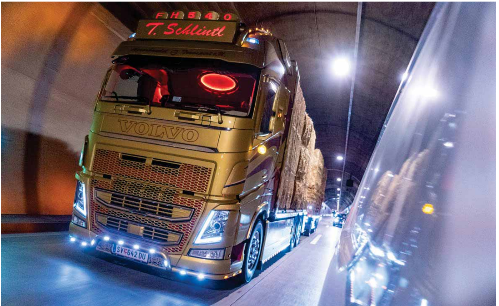
PRÄCHTIG STRAHLT DER VOLVO im Tunnel. Die Schrift des Leuchtkastens ist in Aluminiumblech gelasert, das dem Kontakt mit Ästen besser widersteht.
