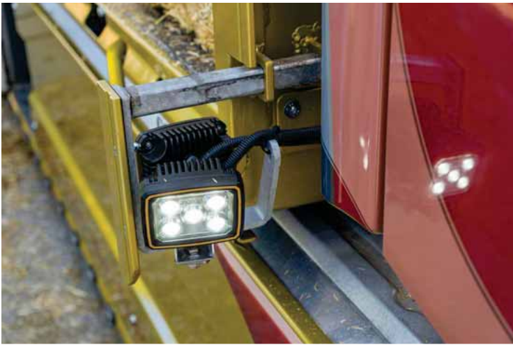
BEI SCHWIERIGEN MANÖVERN und beim Auflegen der Ketten helfen auf Knopfdruck ausfahrende Arbeitsscheinwerfer. Die Kranhydraulik lässt sich mit wenigen Handgriffen von den Anschlüssen am Chassis trennen.
