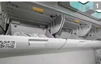
1 DIE FÄCHER an der Rückwand fassen je rund 36 Liter und schwenken wie Gepäckkonsolen im Flugzeug auf.
