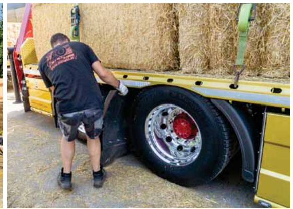
WENN DIE FUTTERVORRÄTE zur Neige gehen, liefert Klaus alle Arten von Strohballen. Dabei muss die Fracht sauber verladen und gründlich gesichert werden. Die seitlichen Schienen mit den Löchern für die Lastsicherung sind extra aus Edelstahl gefertigt, damit hässlicher Rost keine Chance hat.
