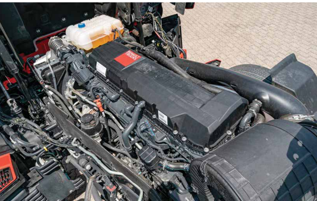
DER DTI-13-MOTOR stammt aus dem Konzernbaukasten von Volvo. Charakteristisch ist die Bauweise mit ungekühlter Abgasrückführung, die recht viel Adblue kostet. An der Vorderachse des Testwagens sitzen leichte Einblattfedern.
