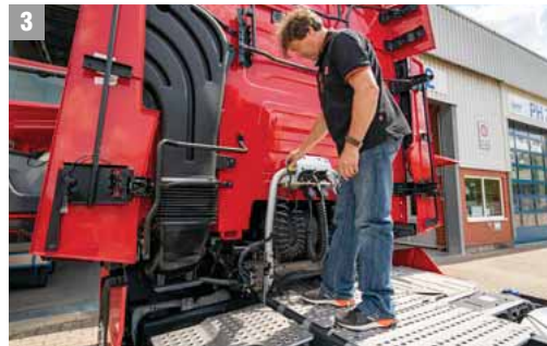
4 DER DACHSPOILER lässt sich einfach über das in Brusthöhe montierte Gestänge verstellen.
