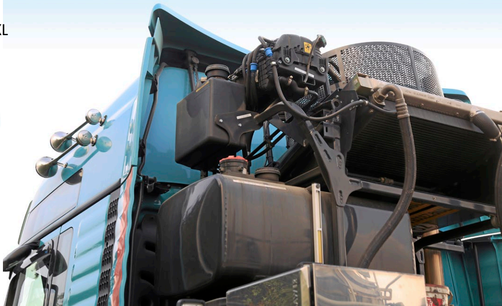
Unter dem Kühler hat die Zugmaschine einen Tank für die Zusatzhydraulik zur Trailerversorgung.
