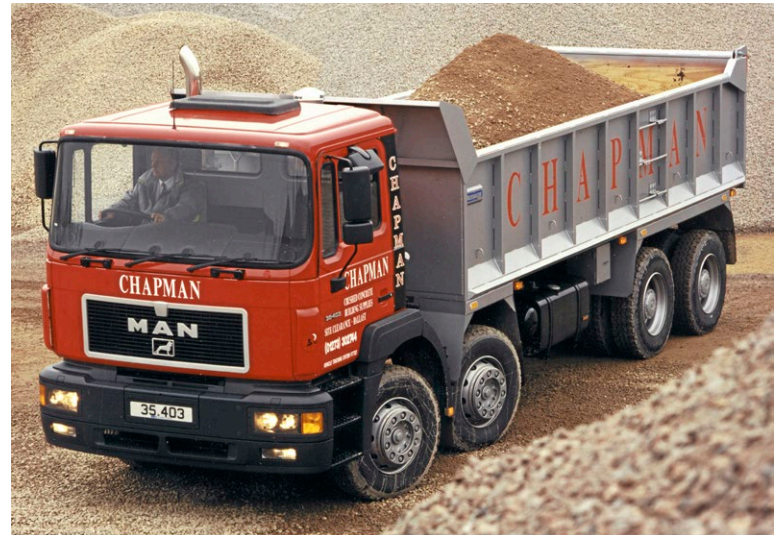
1997: F2000-Kipper kommen erstmals mit luftgefederten Hinterachsen.
