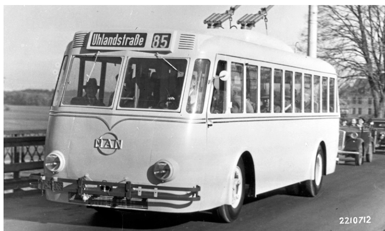
Dieser Oberleitungsbus MKE von 1948 fuhr als erster MAN-Bus mit selbsttragendem Gerippe vor, das bald Standard werden sollte.
