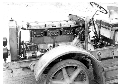
Dank Direkteinspritzung wiegt der Diesel kaum mehr als die damaligen Ottomotoren.
