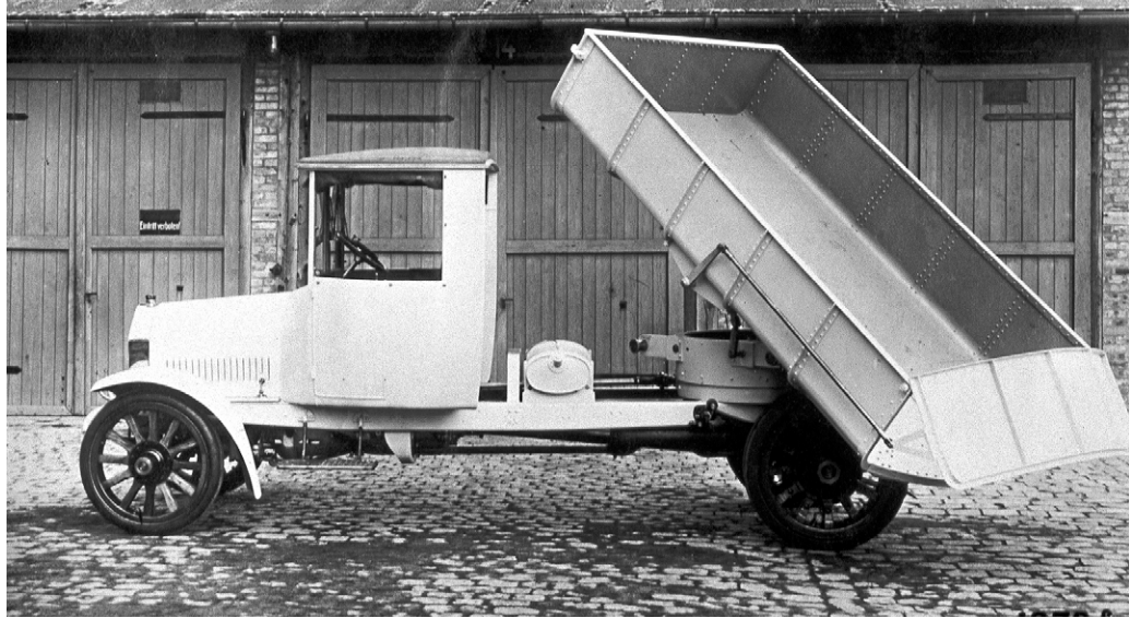
1921: Erster Dreiseitenkipper von MAN, und gleich mit frei schwenkbarer Brücke.
