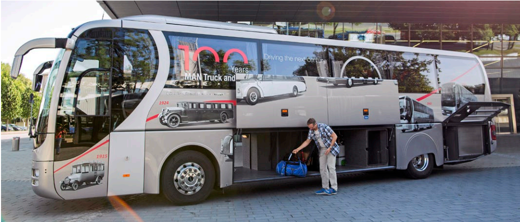
Zwischen den Achsen wartet der Lion's Coach mit rund über acht Kubikmeter Stauraum auf.
