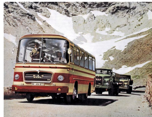
Mit dem schmucken Reisewagen 535 HO kehrte MAN kurzzeitig zur Blattfeder zurück.
