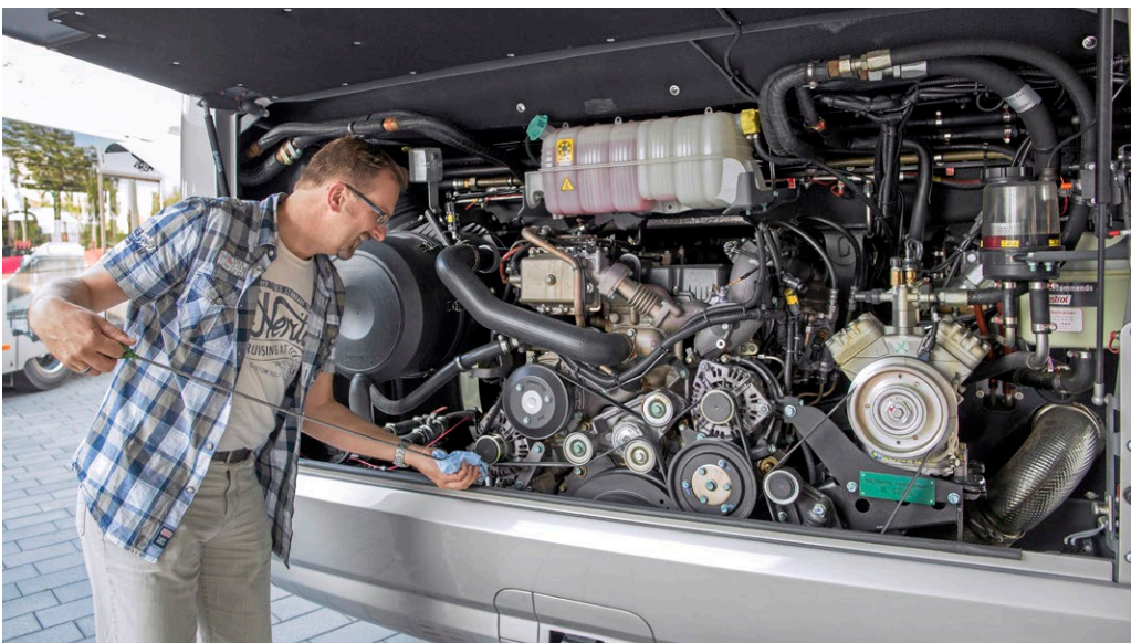
Ein Bestseller aus dem MAN-Regal im Heck: D26-Common-Rail-Motor mit 440 PS und 2.100 Nm.
