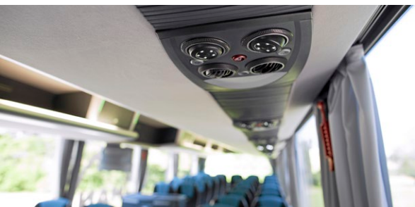
Die modernen Servicesets mit LED-Leuchten lassen sich bei Bedarf einfach umbauen.
