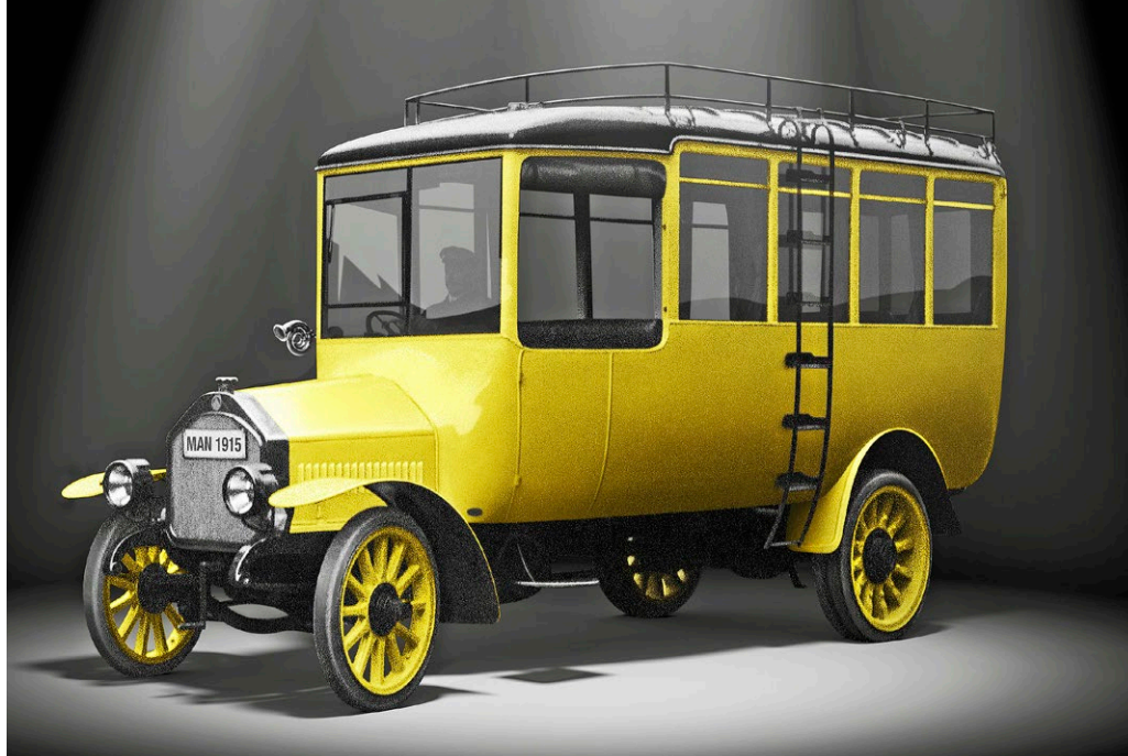
Die ersten M.A.N.-Saurer-Busse für Laupheim wurden 1915 noch mit Ketten angetrieben.
