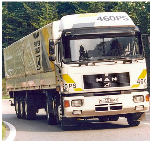
Mit 460 PS aus 18,7 Liter Hubraum stellt der V10 von 1987 alle anderen in den Schatten.
