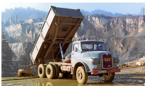
1968: Dreiachser mit der Achsformel 6x4 fahren in den 60er-Jahren vor.
