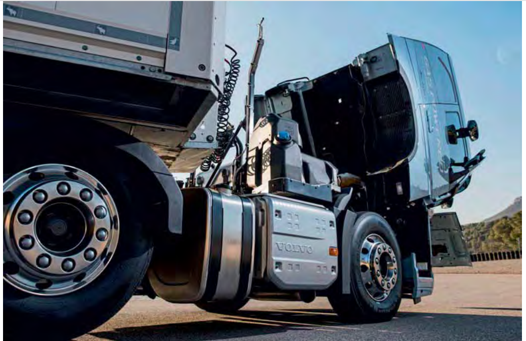
Am Rahmen findet die komplette Abgasfabrik sowie Diesel- und darüber Adblue-Tank Platz.
