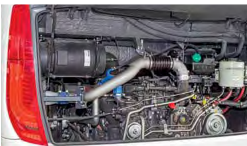
Die Abgasanlage teilt sich auf und ist rechts und links neben dem DAF-Motor platziert.
