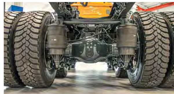
Beim Zahnwerk hinten bietet Iveco die Wahl zwischen Hypoid- und Außenplanetenachsen.
