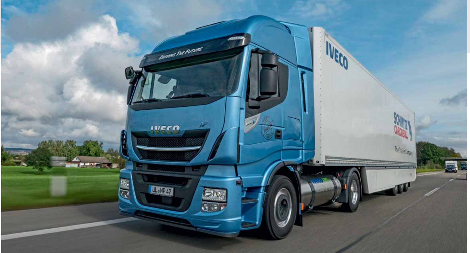
Der 8,7 Liter große Cursor 9 im Stralis NP 400 machte als fernverkehrstauglicher Erdgasantrieb den Anfang; das Modell bleibt auch im Programm.
