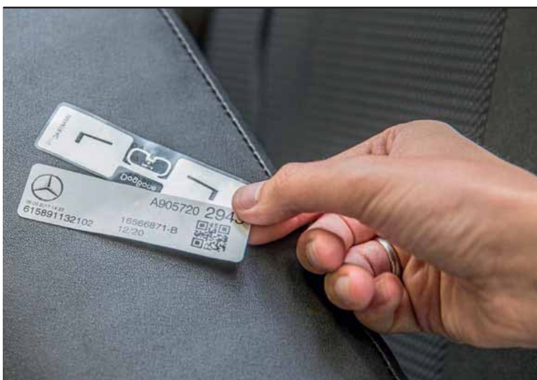
Unauffällige Intelligenz: Die Bauteile werden noch im Zulieferbetrieb mit den sogenannten RFID-„Tags“ versehen. In deren Mini-Computerchips sind wertvolle Daten gespeichert.
