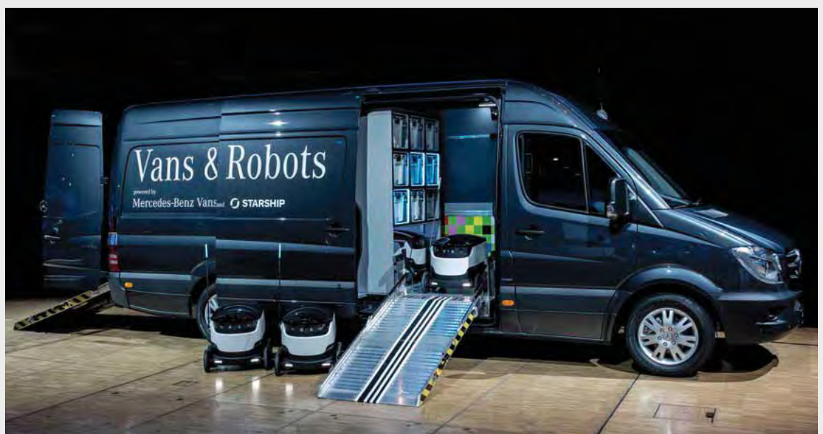
Ein Mercedes-Benz Sprinter dient acht Robotern als mobiler Belade- und Transport-Hub.
