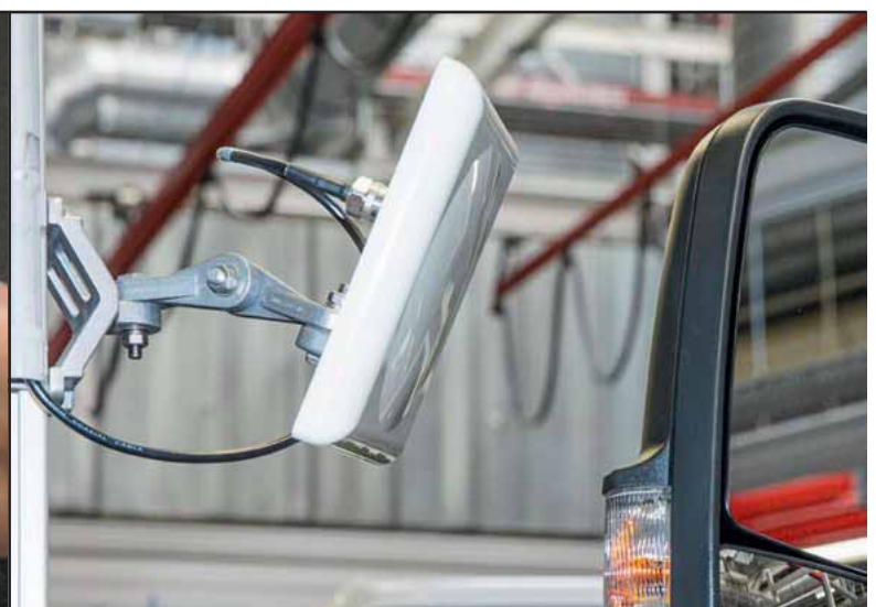
Datenleser im Einsatz: Die weißen Lesegeräte aktivieren die elektronischen Etiketten – sie liefern mittels Funkwellen die Energie, die nötig ist, um die gespeicherten Informationen zu übertragen.
