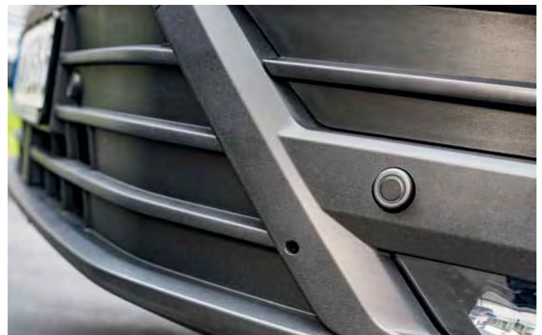
Kleine Erhebungen in der Stoßstange verraten die Position der Sensoren. Die Technik lässt sich relativ einfach integrieren.
