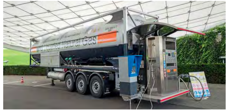
Schnelle Infrastruktur: Die Gasbetreiber errichten Trailer-Tankstellen.
