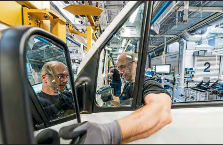
Die Pilotphase im Daimler-Werk Ludwigsfelde ist schon voll im Gange: Aktuell werden sowohl die Seitenspiegel als auch die Sitze mittels der RFID-„Tags“ identifiziert und lokalisiert.
