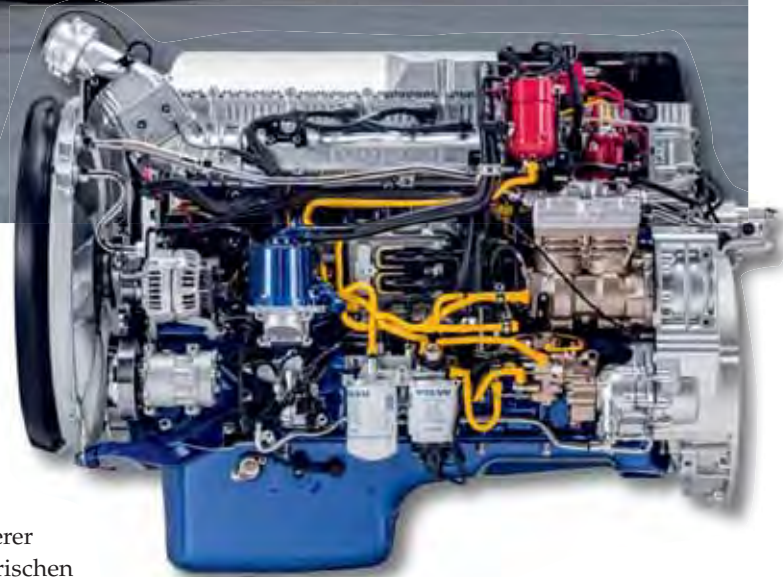
Gelb (Diesel) und rot (CNG) sind die Anpassungen gekennzeichnet, die aus dem D13 den G13 machen.
