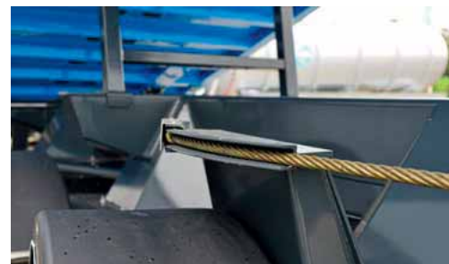
Die Lenkung der ersten Achse erfolgt über ein Seil vom Königszapfen aus.
