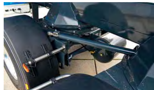
Große Köpfe an der Lenkstange der dritten Achse sollen die Lebensdauer verbessern.
