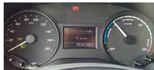
Rekuperationsstärke und Leistungsabgabe werden mittels Tachonadel visualisiert.
