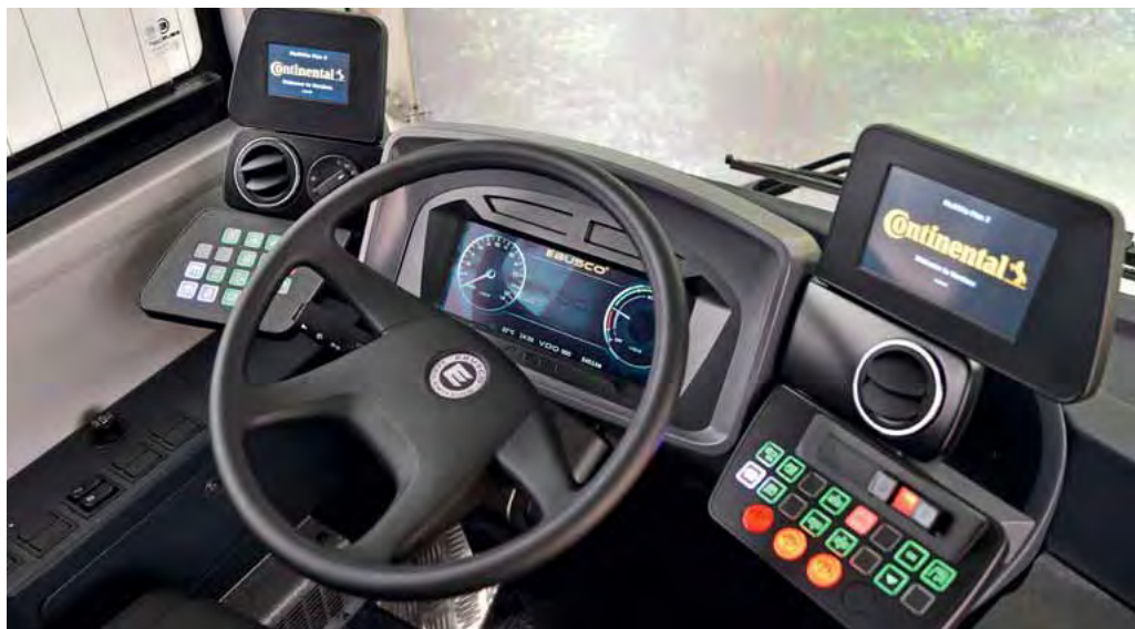
Das modulare Digitalcockpit von Continental bietet 12-Zoll-Display und programmierbare Tasten.
