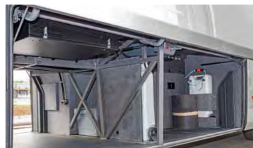
Eine 3,53 Meter große Klappe verbirgt links den rund 8,1 Kubikmeter großen Kofferraum.
