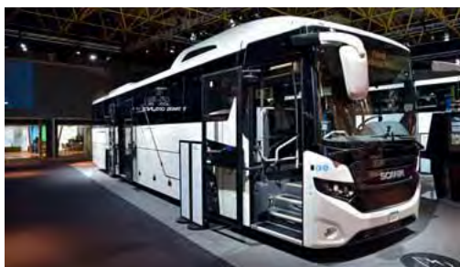
Scania zeigt seinen InterLink LD mit einem Parallelhybridantrieb und bis zu 55 Sitzen.
