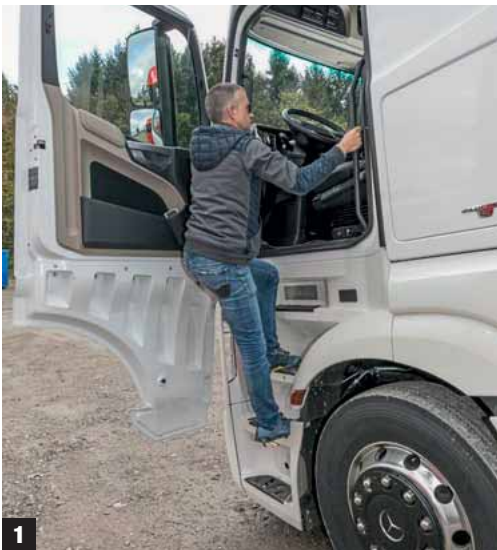
1 Verlangt Elan: Vier Stufen hat der Streamline-Pilot zum ebenen Flur hin zu meistern.
