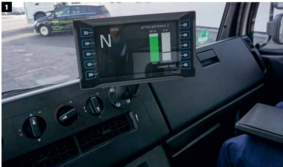
1 Zusatzdisplay auf dem altertümlichen Armaturenbrett des Vario. Die Serienlösung ist noch offen.
