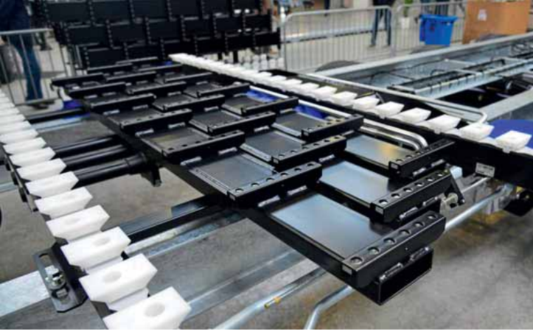
Die seitlich versetzten Traversen verbinden Antrieb und Schubboden. Am Querträger fixierte Gleitkämme führen die verschiebbaren Planken.
