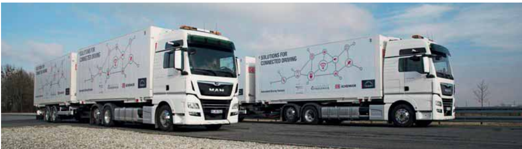
Zunächst startet der Versuch von MAN und DB Schenker mit zwei Wechselbrücken-zügen auf Basis TGX 26.500. Ein drittes Fahrzeug könnte dem Vernehmen nach im Laufe des 20 Monate langen Versuchs folgen.
