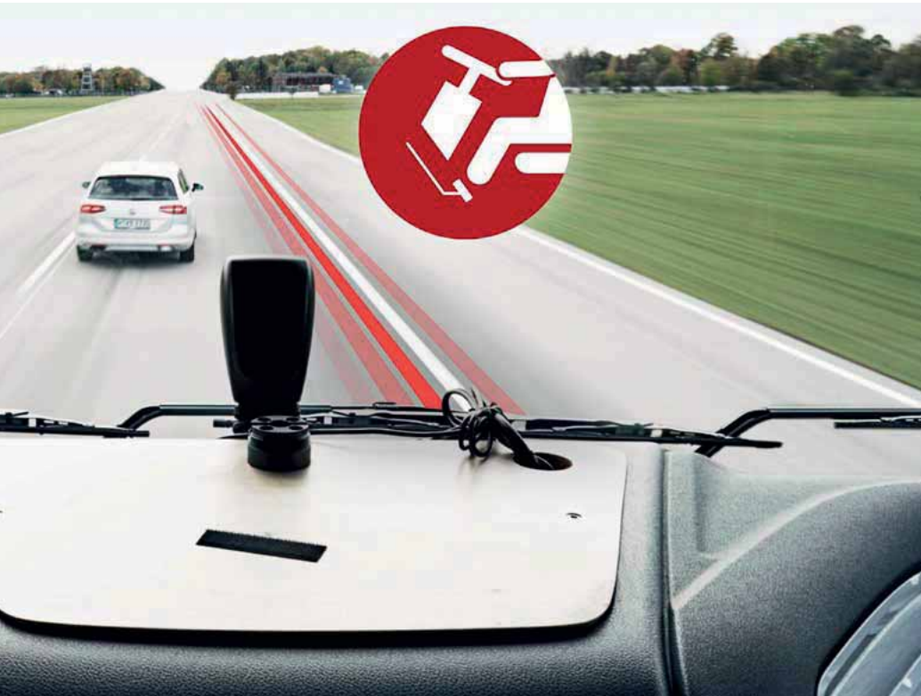
Die Funktion Highway Departure Braking bremst das Fahrzeug auf dem Seitenstreifen, sofern LDW ignoriert wird.
