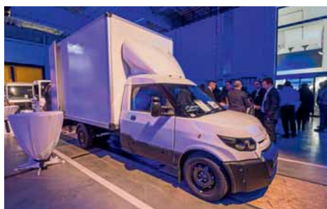
E-Volumentransporter: Streetscooter mit Humbaur-Aufbau und Ladebordwand.
