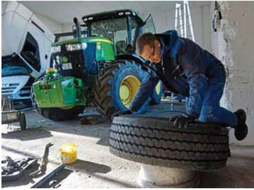
▲ Einen Lkw-Reifen hat Profi Mauermann innerhalb von zehn Minuten getauscht – auch ohne Montagemaschine.
