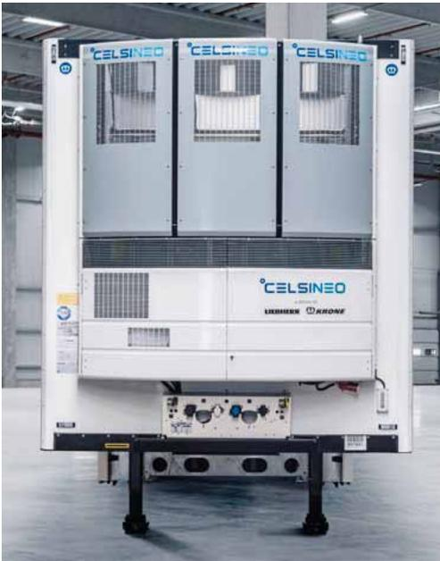
Drei autark und redundant agierende Kälteaggregate sorgen für die Transportkühlung.
