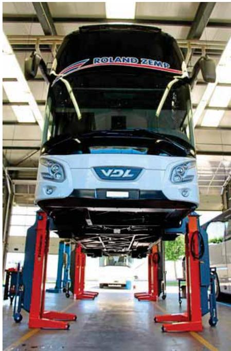
▲ Die Radgreifer von Finkbeiner verfügen über einen Batteriebetrieb, der die Rüstzeit reduzieren soll.
