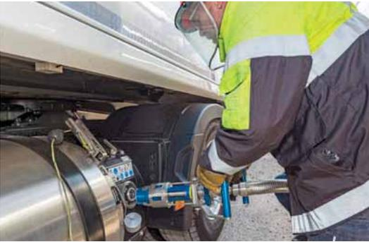
Die LNG-Tanks sind je nach Lkw-Marke unterschiedlich ausgeführt (Druck, Temperatur).
