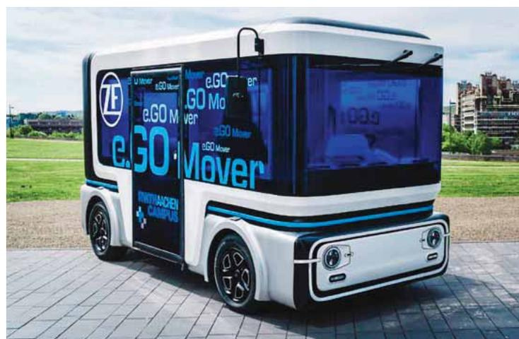
Der im Joint Venture mit der e.GO Mobile AG entstandene, hoch automatisierte und elektrisch fahrende e.GO Mover kann je nach Aufbau Menschen oder Waren transportieren.
