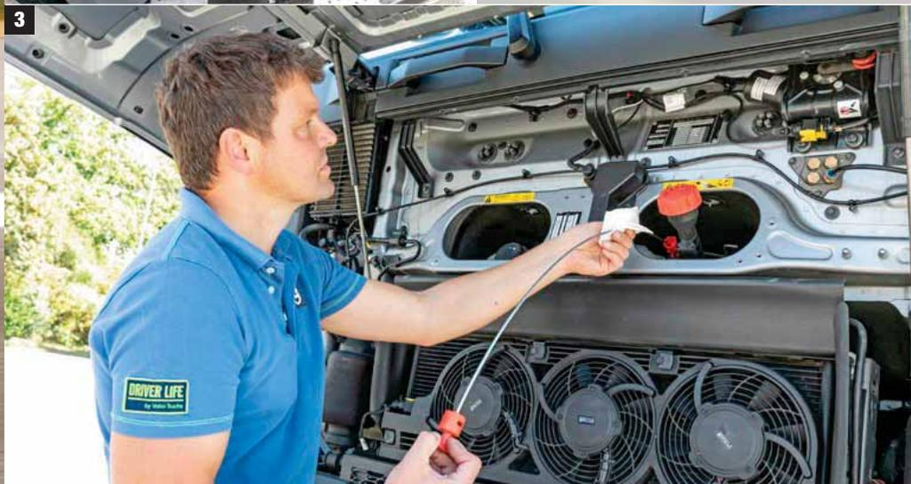
1 Der Kompressor ist Teil der integrierten Standklimaanlage I-Park-Cool.
