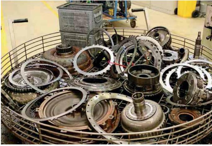
▲ **Puzzle für Profis:** Bei ZF in Holzwickede nahe Dortmund werden unter anderem Busgetriebe komplett zerlegt und von Grund auf neu aufgesetzt.
