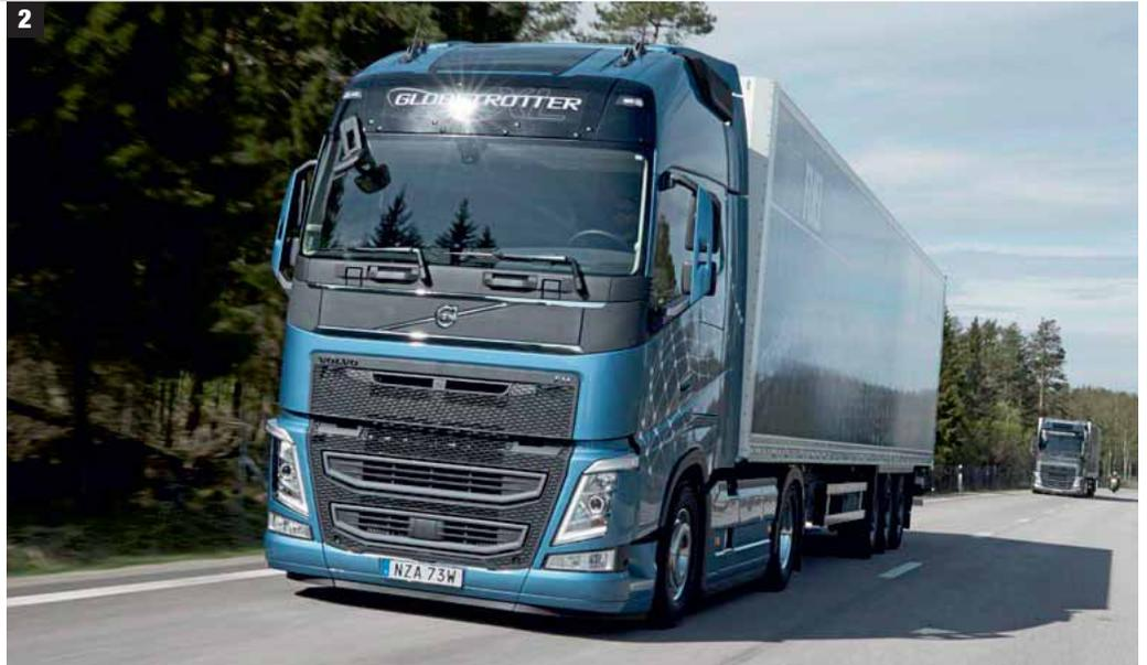
**Wer beim Wechsel** auf die FH-460-Test-Lkw allerdings harte Einschnitte vermutete, der sah sich getäuscht. Und das, obwohl deren Chassis ohne vordere Luftfederung auskommen musste, sie mit dem Standard-Direktganggetriebe samt zwölf Gängen versehen waren und auf den lang übersetzten Hinterachsen (2,31) standen.
