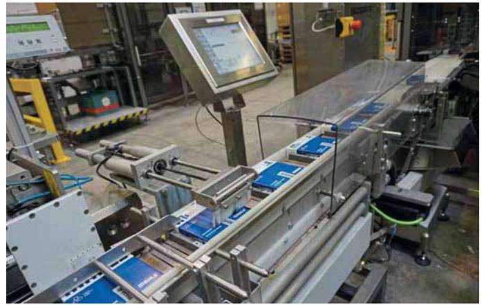
▲ Die Verpackung der hauseigenen Kolbenringe erfolgt bei Mahle vollautomatisch.
