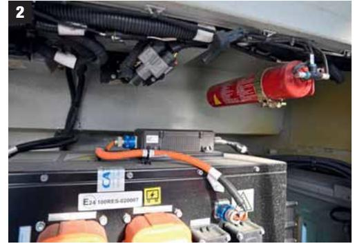
**1 Scania will seine Elektrobuse serienmäßig mit Brandlöschanlagen ausrüsten.**
