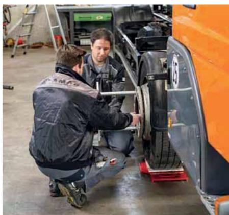
▲ Bei der Achsvermessung legt Henkel unterstützend auch mal selbst Hand an.
