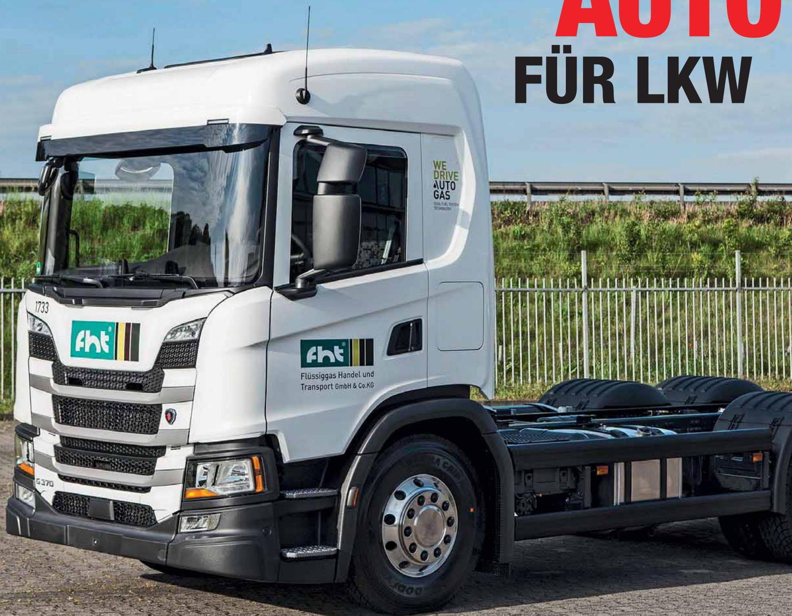
**Vorstellung:** Auf die Verbrennung von Autogas (LPG) greifen hierzulande mit Vorliebe Fahrer leistungsstarker Pkw mit V8-Benzinmotoren zurück. Die FHT Flüssiggas Handel und Transport GmbH & Co. KG aber nutzt das Prinzip nun auch für einen hochvernünftigen Euro-6-Diesel-Lkw.
