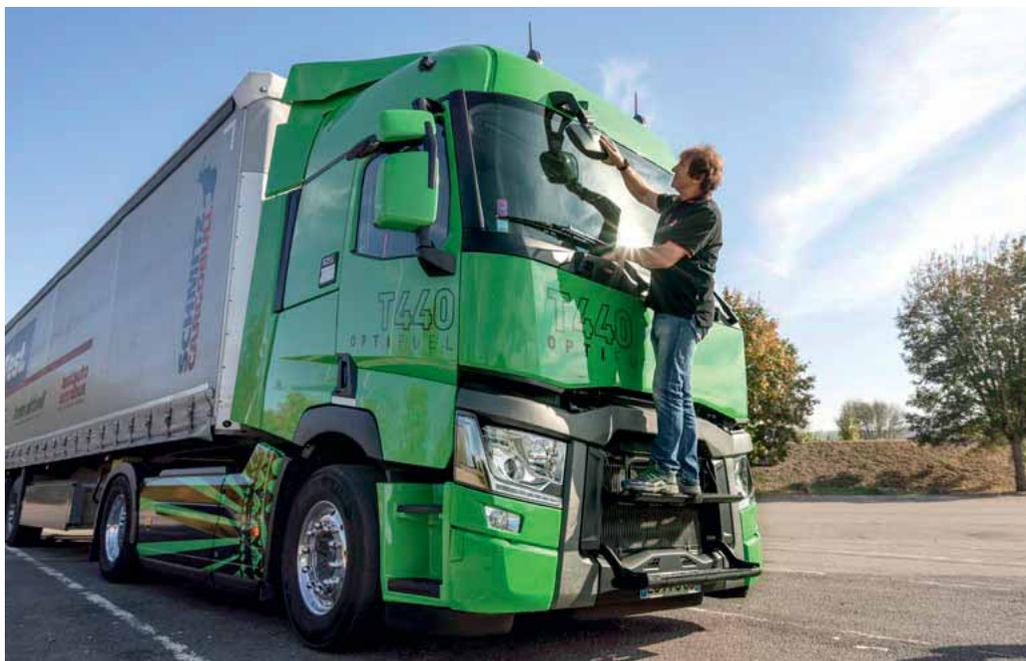
Die beiden Klappstufen in der Front sind zum Scheibenputzen oder auch als Freisitz optimal.
