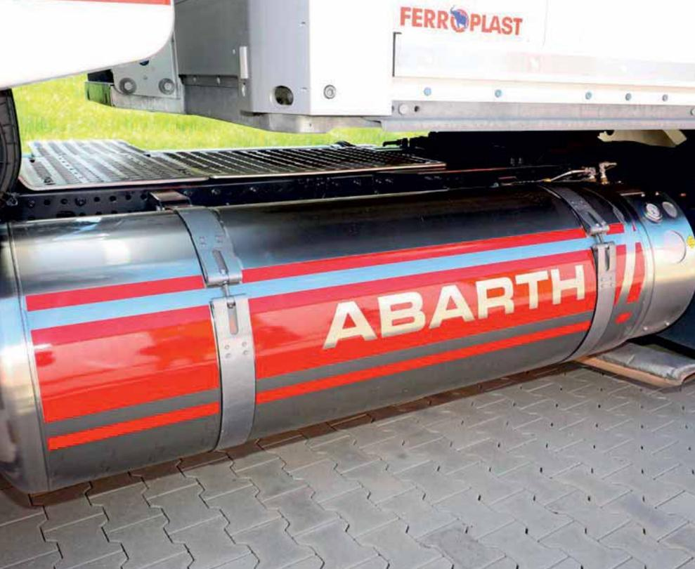
Zwei Tanks à 540 Liter kann der Iveco maximal auffahren. Macht 390 Kilogramm LNG.
