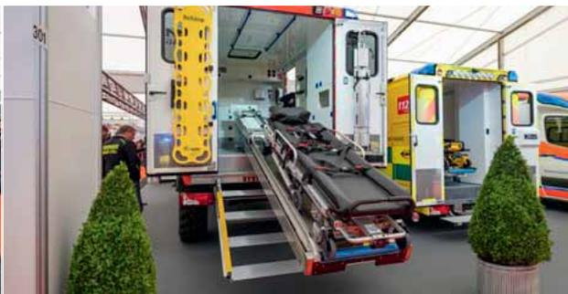
Der größte RTW auf der Messe: Der von System Strobel aufgebaute Unimog U4023 wird der Werksfeuerwehr des Bergbauunternehmens Mibrag dienen. Im klimatisierten Koffer steckt eine luftgefederte Patientenlagerung mit elektrischer Einzugshilfe.
