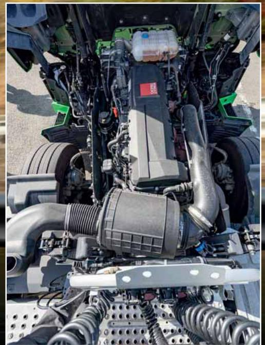
Mit ungekühlter AGR (fast) ein SCR-only-Motor: der Renault DTI 13, im Test in der 440-PS-Basismotorisierung.
