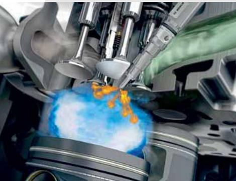
Verbrauchsverhalten und die Option auf tendenziell mehr Drehmoment lauten die Argumente, die fürs Dieselprinzip beim Gasmotor sprechen. Doch braucht es bei dieser heutzutage von Volvo favorisierten Technik die verschiedensten Zutaten, deren Spektrum von verschiedenen Tanks (LNG/Diesel/Adblue) bis hin zu komplexer Abgasnachbehandlung mit SCR-Kat und Dieselpartikelfilter reicht. Das kostet Platz, schränkt vor allem bei Sattelzugmaschinen das mögliche Tankvolumen und somit die Reichweite ein.
