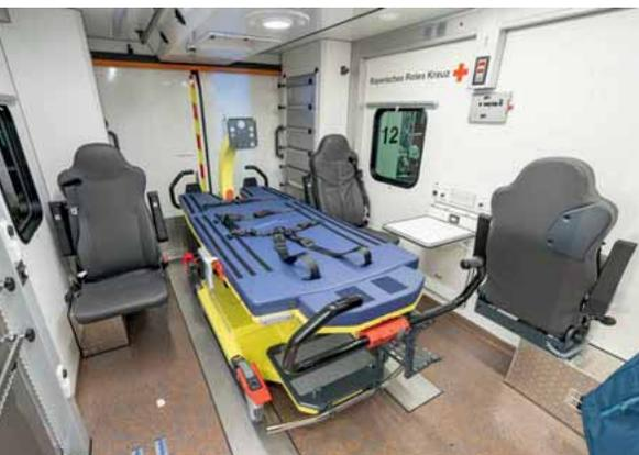
Intensivtransportwagen auf dem Iveco Eurocargo ML 120 E28 mit 12 Tonnen zGG, Luftfederung und Allison-Vollautomat, wie ihn das Bayerische Rote Kreuz bei Fahrtec bestellt hat. Der Aufbau besteht aus einem Aluminium-Wechselkoffermodul mit Bär-Ladebordwand und Aufdachklimaanlage.
