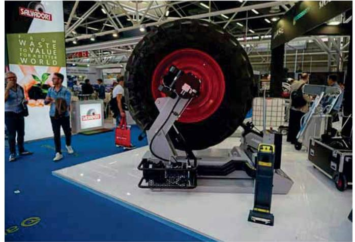
▲ Die Beissbarth-Gruppe präsentierte schweres Gerät: Die Montagemaschine Jumbo TCS 60 R von Sicam stemmt auch Dumperreifen von 2,8 Tonnen Gewicht.
