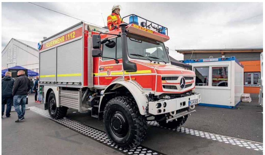
Mercedes-Benz Special Trucks hatte unter anderem einen U5023 mit Lentner-Aufbau als TLF 3000 für die Waldbrandbekämpfung aufgefahren. Der Sprühbalken unter der Frontstoßstange dient dem Eigenschutz. Der Unimog bringt 3.000 Liter Wasser und 120 Liter Schaum an die Einsatzstelle.
