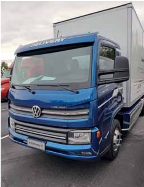
Mit seinem 200 kW starken E-Antrieb fährt sich der VW eDelivery ausgesprochen flink.
