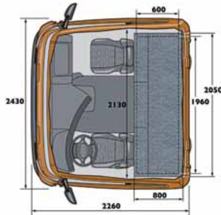
Scania folgte 2016 mit den neuen Fahrerhäusern, die es vorn nur noch auf 2.310 statt wie zuvor 2.430 Millimeter in der Breite bringen.
