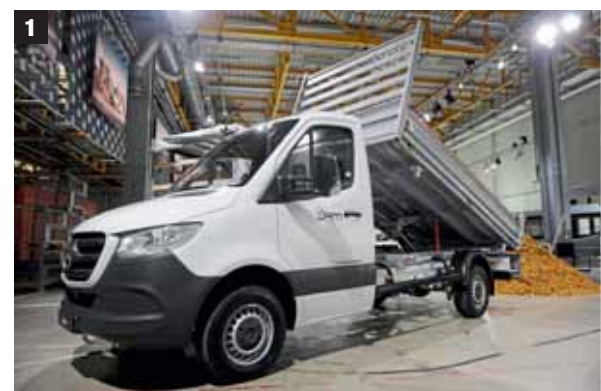
1 Dank des großzügigen Einsatzes von Aluminium bringt die JPM-Kippbrücke nur 490 Kilogramm auf die Waage.
