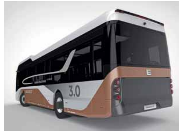
Die gerundete Plexiglasscheibe im Heck wurde durch die dort fehlenden Batterien ermöglicht.
