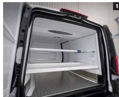
1 Der „Polarfuchs“ kommt mit einer vom Bordnetz gespeisten Unterflur-Elektro-Kühlanlage – das spart Batterien und Gewicht. 2 Einen ersten Pilottest hat der lokal emissionsfreie Lieferwagen bereits bestanden.
