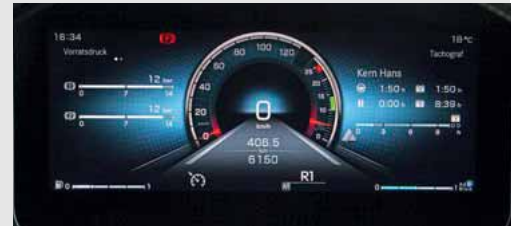
Die Advanced-Variante fasst Tacho und Drehzahlmesser in einem einzigen Rundinstrument zusammen.
