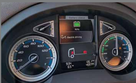
Elektro-CF: angepasstes Display für Batteriekapazität und Rekuperation.
