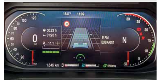
Die Tachonadel schwingt im, die Nadel des Drehzahlmessers gegen den Uhrzeigersinn.
