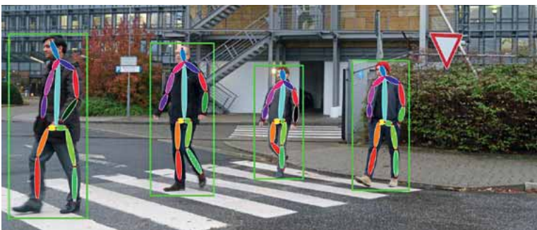
Neuronale Netze können Bewegungsabsichten von Fußgängern erkennen und darauf reagieren, etwa indem das Fahrzeug in Bremsbereitschaft versetzt wird.
