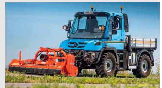
Der Geräteträger nimmt Anbauten an Front und Heck sowie zwischen den Achsen auf.
