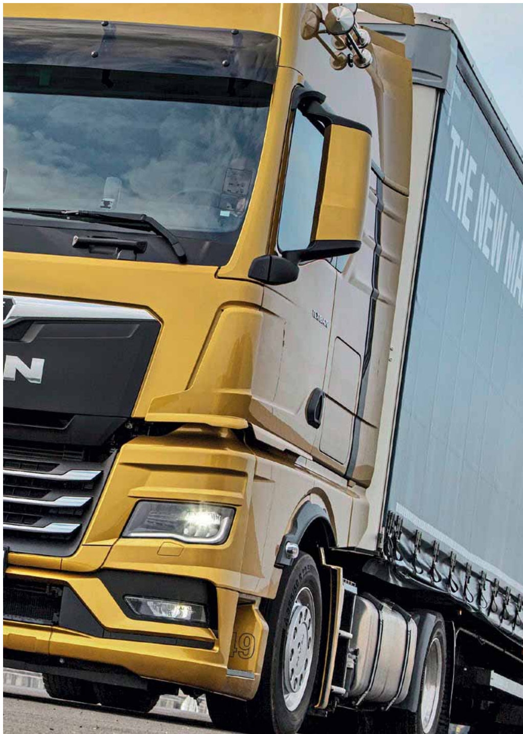
Etwas schlankere Spiegel und neue Beplankung der Ecken sollen die Aerodynamik verbessern.
