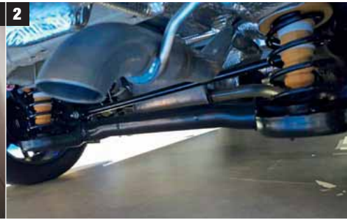
2 Tonnenfederung für mehr Komfort: Verbundlenkerachse mit Panhardstab.
