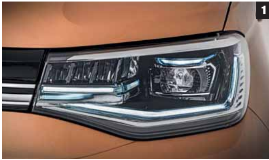
1 Neues Gesicht: LED-Scheinwerfer im Golf-8-Design mit LED-Tagfahrlichtblenkern.
