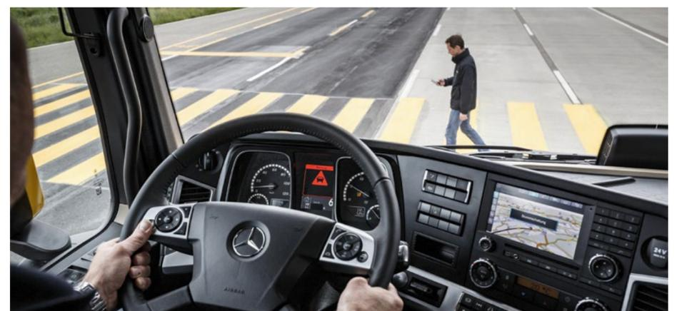
überwacht kontinuierlich die Schleppkurve des Trailers. Drohe der Anhänger beispielsweise, Fußgänger, Radfahrer oder eine Ampel zu touchieren, spricht der Assistent an und warnt optisch und akustisch. Der Abbiegeassistent des ABA 4 funktioniert ebenfalls mithilfe des Seitenradars, allerdings im Bereich von 0 bis 90 km/h. Erkennt der Assistent neben dem Lkw ein bewegliches
