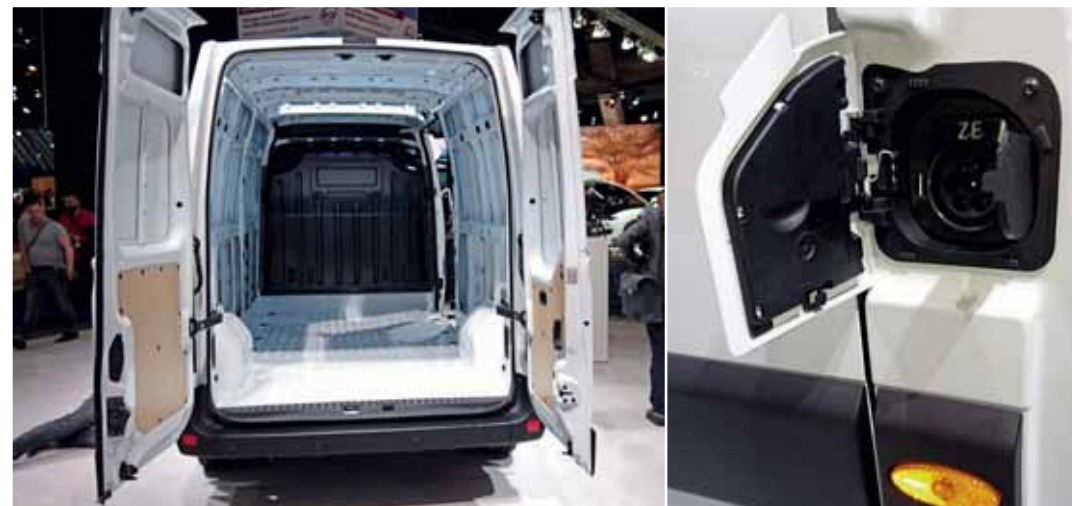
Üppiger Laderaum dank Unterflur-Akku (links), die Ladesteckdose ersetzt den Tankstutzen.
