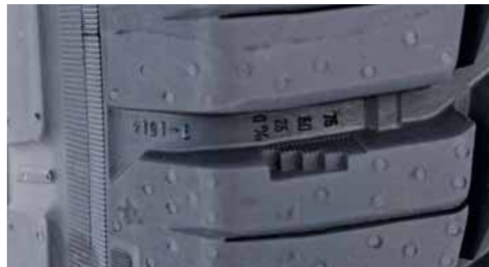
Der Reifenindikator des Michelin Agilis Cross Climate zeigt an, wann der Reifen gewechselt werden muss.
