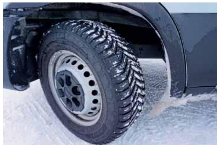
Der neue Michelin verfügt über trapezförmige Verstärkungen der Seitenwand, die sie vor Beschädigungen schützen sollen.
