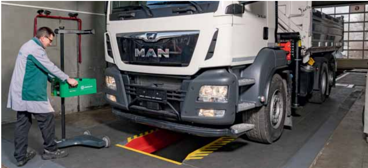
Der Scheinwerfereinstellplatz ist bereits in Betrieb. Rechts die nachträglich angebrachten Markierungen für die Vorderachsen.
