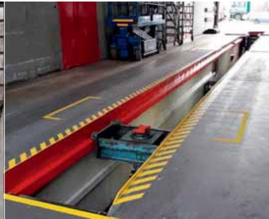
Der Scheinwerfereinstellplatz ist bereits in Betrieb. Rechts die nachträglich angebrachten Markierungen für die Vorderachsen.
