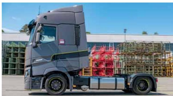
Renault T 440 X-Low: High Sleeper Cab und 948 Millimeter Aufsattelhöhe.
