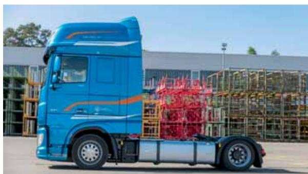
DAF XF 450 FT Low Deck: Super Space Cab und 910 Millimeter Aufsattelhöhe.
