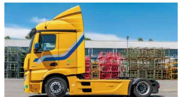
Mercedes Actros 1842 Low Liner: Streamspace-Fahrerhaus und 921 Millimeter Aufsattelhöhe.
