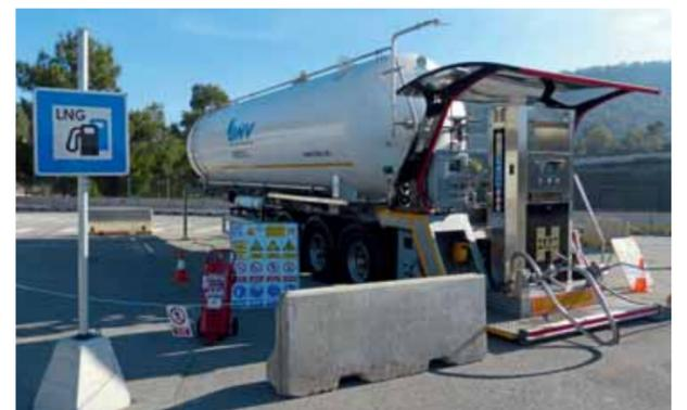
Eine mobile LNG-Tankanlage ist die Alternative zur noch nicht flächendeckend ausgebauten Tankinfrastruktur.
