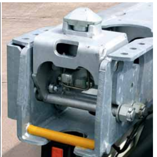
Die Klapp-Lock-Verriegelung (l.) fixiert den vorderen Container bei Beladung mit zwei 20-Fuß-Containern. Der Step-Lock (r.) sorgt bei Bedarf für eine erhöhte Fixierung von Containern ohne Tunnel.
