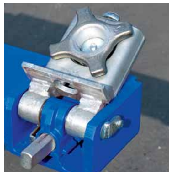
Die Klapp-Lock-Verriegelung (l.) fixiert den vorderen Container bei Beladung mit zwei 20-Fuß-Containern. Der Step-Lock (r.) sorgt bei Bedarf für eine erhöhte Fixierung von Containern ohne Tunnel.
