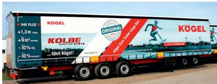
1,3 Meter länger als ein Standardtrailer: Hier eine bahnfähige Variante für die Kolbe Spedition.
