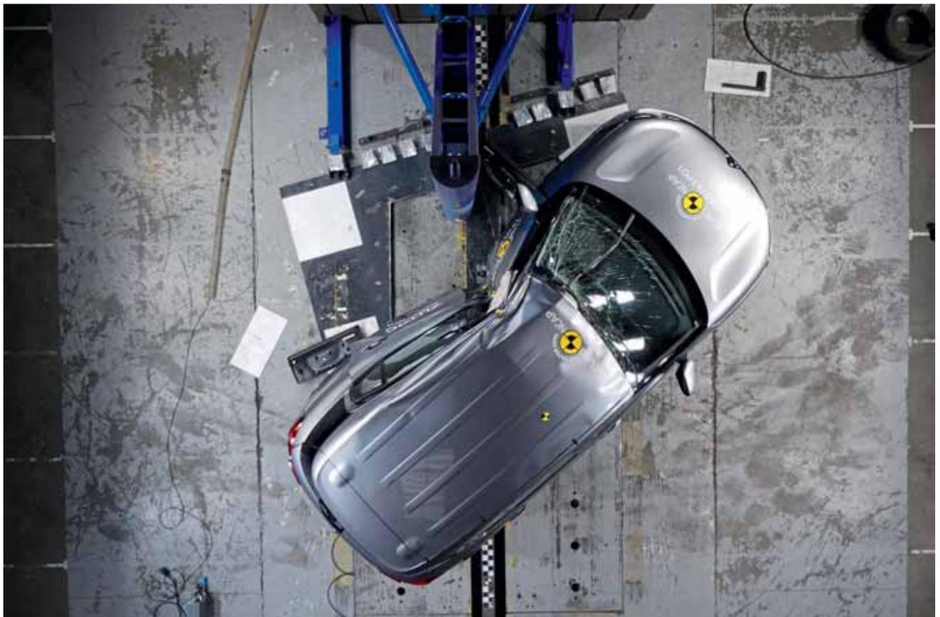
Bei der Simulation des Frontalcrashes wird das Auto mit 64 km/h gegen eine verformbare Barriere gefahren.
