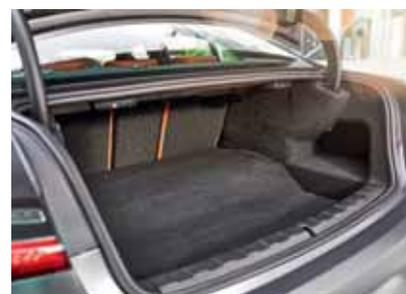
Im Kofferraum entsteht durch den nach hinten versetzten Tank eine Stufe. Der höhenverstellbare Ladeboden gleicht sie aus.
