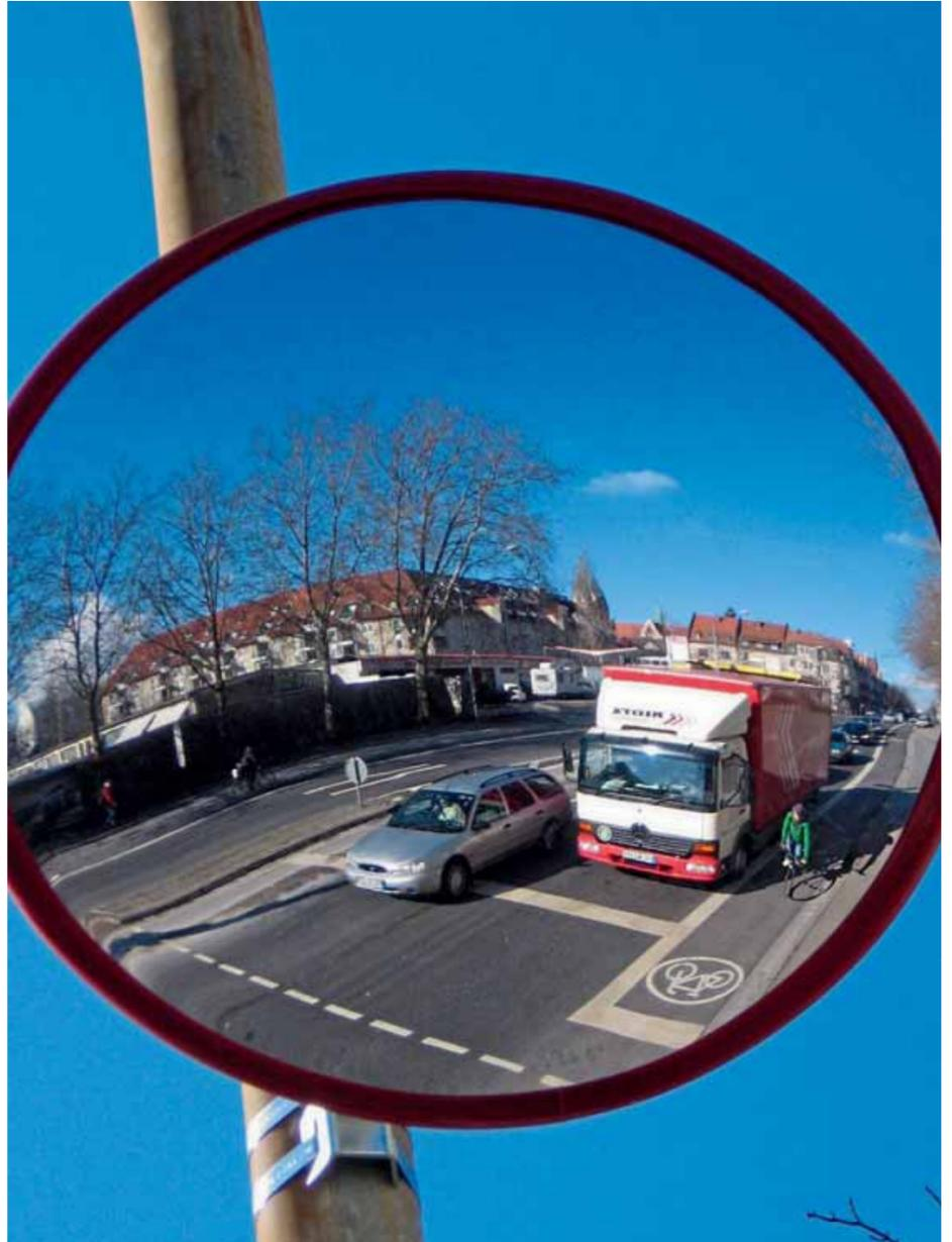
Bei einem Trixi-Spiegel schaut der Lkw-Fahrer nicht wie bei herkömmlichen Verkehrsspiegeln um die Ecke, sondern auf den Bereich rechts neben dem Fahrzeug.
