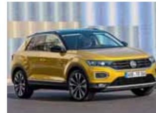
**Antrieb** 1.968 cm<sup>3</sup>; 4 Zylinder; Siebengang-Doppelkuppl., Allradantrieb
