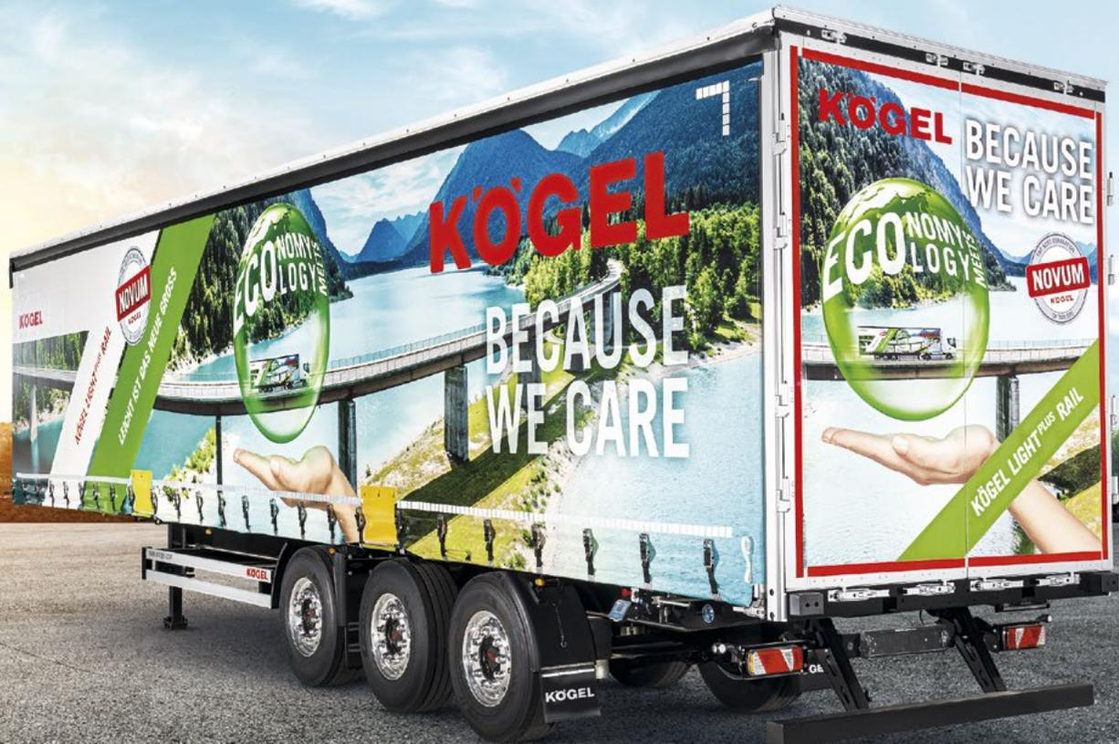
Der Kögel Lightplus steht mit einer reduzierten Rahmenhalshöhe und einem gewichtsoptimierten Rahmen für eine neue Leichtigkeit, die durch den Einsatz von hochwertigen Feinkornstählen gleichzeitig hohe Stabilität und Langlebigkeit ermöglicht
