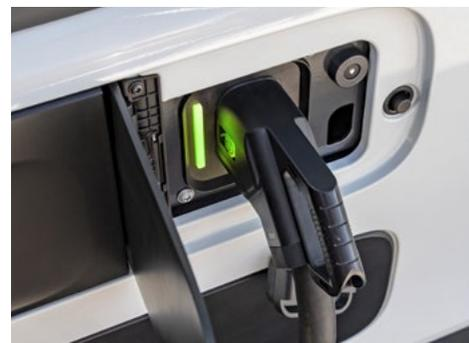
Über die CCS-Ladedose fließen bis zu 400 kW. Das sollte reichen, um in unter zwei Stunden vollzuladen. Später kommt der MCS-Anschluss für ultraschnelles Laden mit einem Megawatt.
