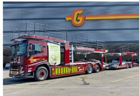
... verschiedenste Autotransporter mit einer konkurrenzlosen Batteriekapazität von bis zu 1.000 Kilowattstunden.
