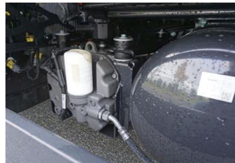
Elektrisch angetriebene Komponenten: Die Betriebsbremse arbeitet weiterhin mit Druckluft, der Luftpresser jetzt allerdings mit Batteriestrom.
