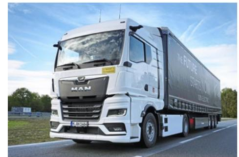
Als Sattelzug darf der eTGX bis zu 42 Tonnen wiegen – die zwei »Bonus«-Tonnen wegen des größeren Leergewichts der BEV machen's möglich.
