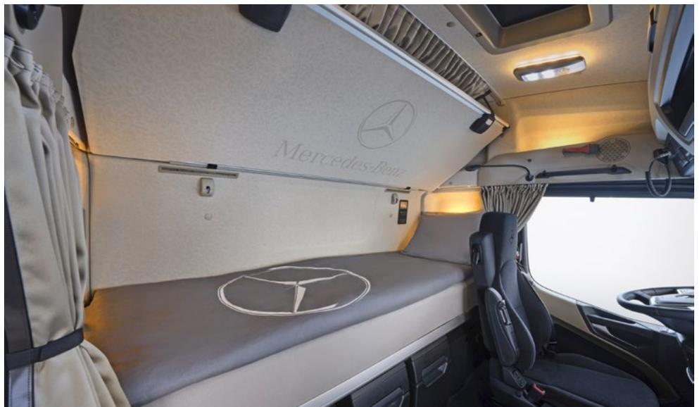
Die ProCabin des großen eActros ist volle 2,5 Meter breit und verfügt dank ihrer Aufsetzhöhe von 765 Millimeter über einen ebenen Fahrerhausboden.
