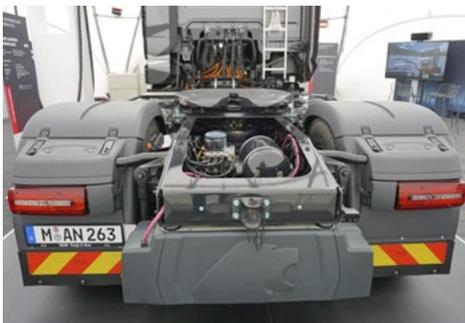
Der Batteriekasten für das 24-Volt-Bordnetz ist größer geworden und hängt jetzt am Rahmenheck, um seitlich Platz für die Hochvolt-Batteriepakete zu machen.
