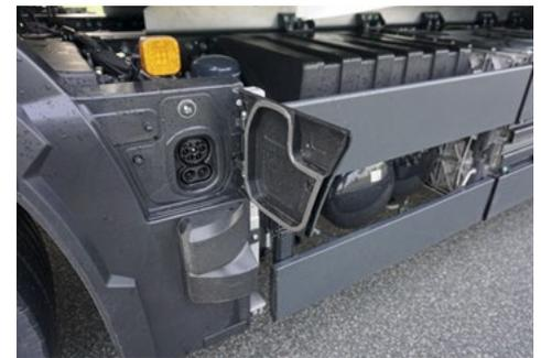
CCS-Anschlüsse können variabel kombiniert links und rechts hinter dem Vorderradlauf und hinten rechts oder links am Rahmen positioniert werden.
