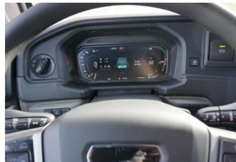
Ungewohnt ist im Cockpit nur das neue, digitale Kombiinstrument. Es zeigt Energieverbrauch/-rückgewinnung und Batterieladezustand an.
