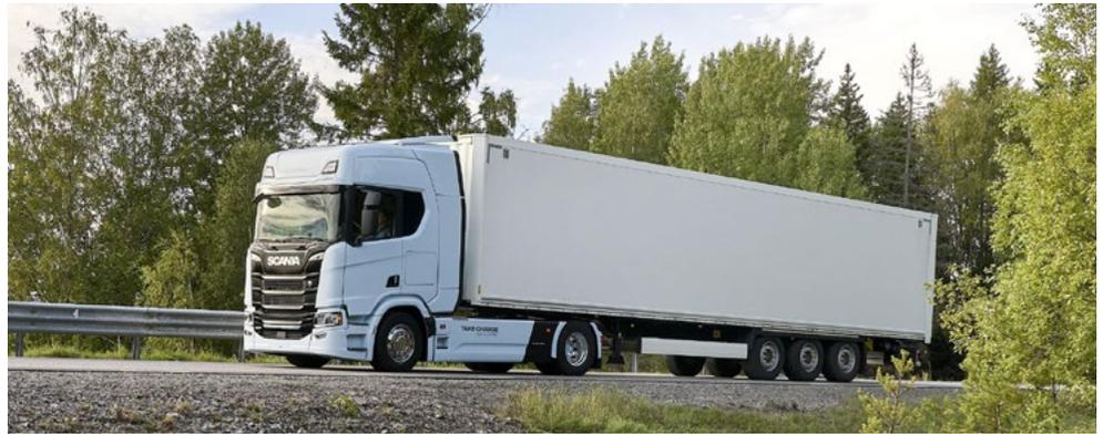
Scania bestückt die E-Lkw für schwere Lasten mit einem Triebstrang mit drei Motoren und bis zu 450 kW.
