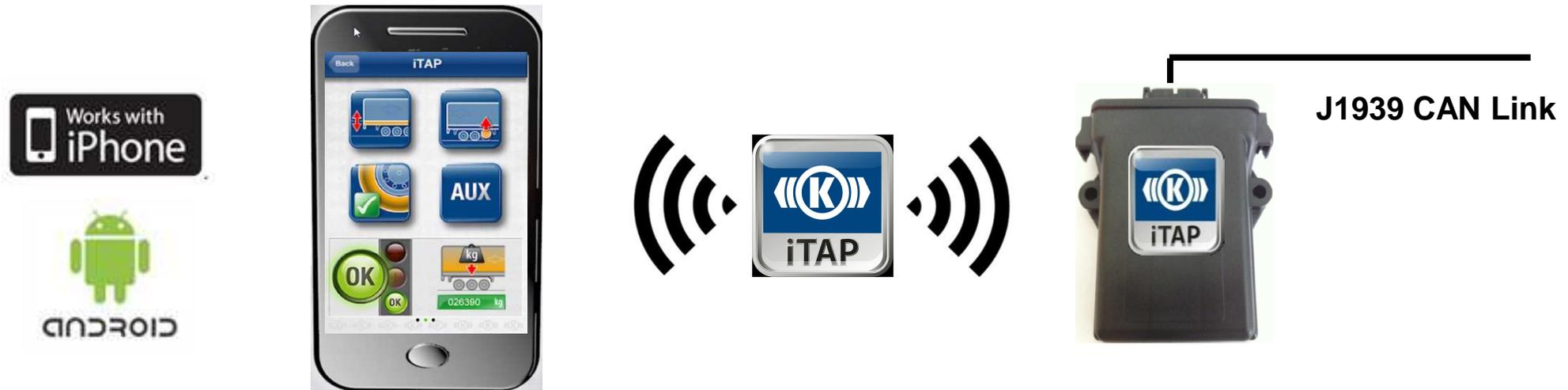
App kommuniziert per WLAN Schnittstelle eines Smartphones/ Tablets mit dem iTAP am Trailer, welches die Befehle über einen CAN-Bus (J1939) an die Brems- und Chassis-Steuerung weiterleitet.
