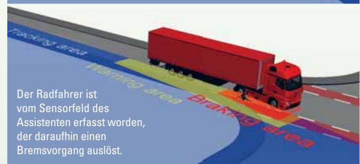
Der Radfahrer ist vom Sensorfeld des Assistenten erfasst worden, der daraufhin einen Bremsvorgang auslöst.
