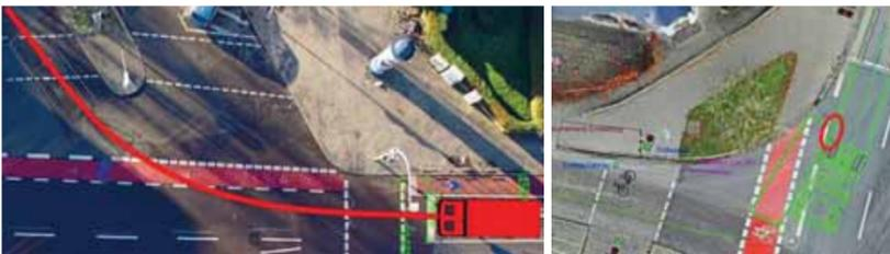
Vor allem an Kreuzungen, bei denen ein Fahrzeug mit einem großen Winkel abbiegt und der Lenkwinkel sehr klein bleibt, kann eine Auslösung des Systems überhaupt nicht oder sehr spät erfolgen.
