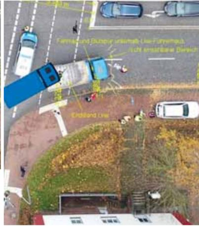
Um abzuschätzen, ob hier ein Abbiegeassistent Wirkung gezeigt hätte, wurde in das Fahrzeug der bestehenden Simulation das angepasste Modul eingefügt und der Vorgang neu berechnet. Es zeigt sich, dass das Feld, das die Bremsung auslöst, die Radfahrerin rechtzeitig erfasst hat und somit der Fahrvorgang automatisch abgebremst wurde.
