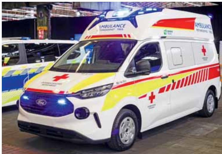
Ohne Kofferaufbau fährt dieser Transit Custom für das Österreichische Rote Kreuz. Durch das Hochdach wächst das Fahrzeug zwar in die Höhe, aber nicht in die Breite – auf alpinen Passstraßen durchaus praktisch.
