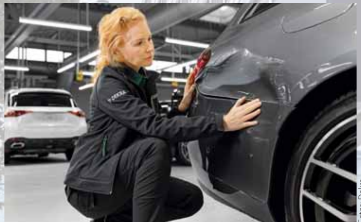
Schadenaufnahme: Dekra-Sachverständige dokumentiert eine Karosserie-Verformung zur Erstellung eines Gutachtens.
