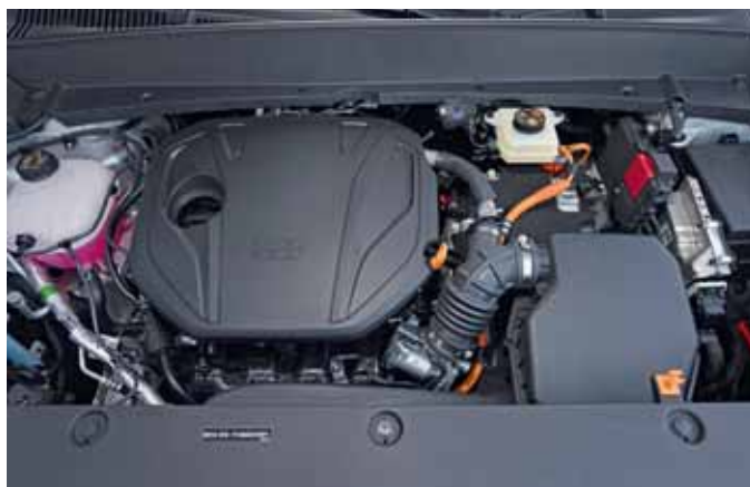
Der 1,5-Liter-Vierzylinder sowie der 160 kW starken Elektromotor bringen es gemeinsam auf 193 kW (262 PS).
