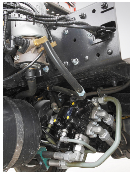
Eine Hydropumpe speist beim 18.440 H 4x4 die Radnabenmotoren an der Vorderachse.
