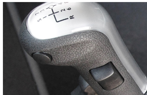
Vorteil der MAN-Handschalter: Kleines Knöpfchen links aktiviert die Kupplungsautomatik.
