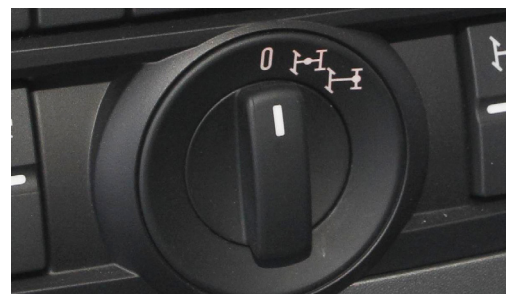
Ein Dreh nach rechts aktiviert den Vorderrad-antrieb, ein weiterer Dreh die Längssperre.
