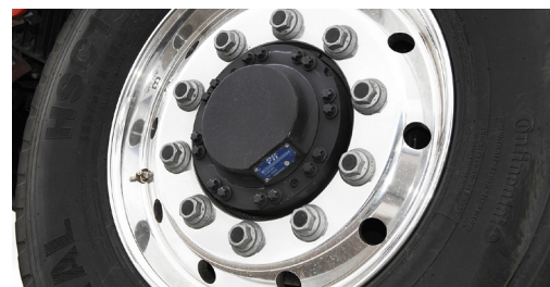
Zu erkennen ist die Hydrodrive-Vorderachse an den markanten Radnaben.
