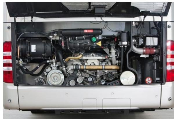
Der stehende Motor verlangt nach mehr Höhe als der liegende Vorgänger. Kühler nun rechter Hand.
