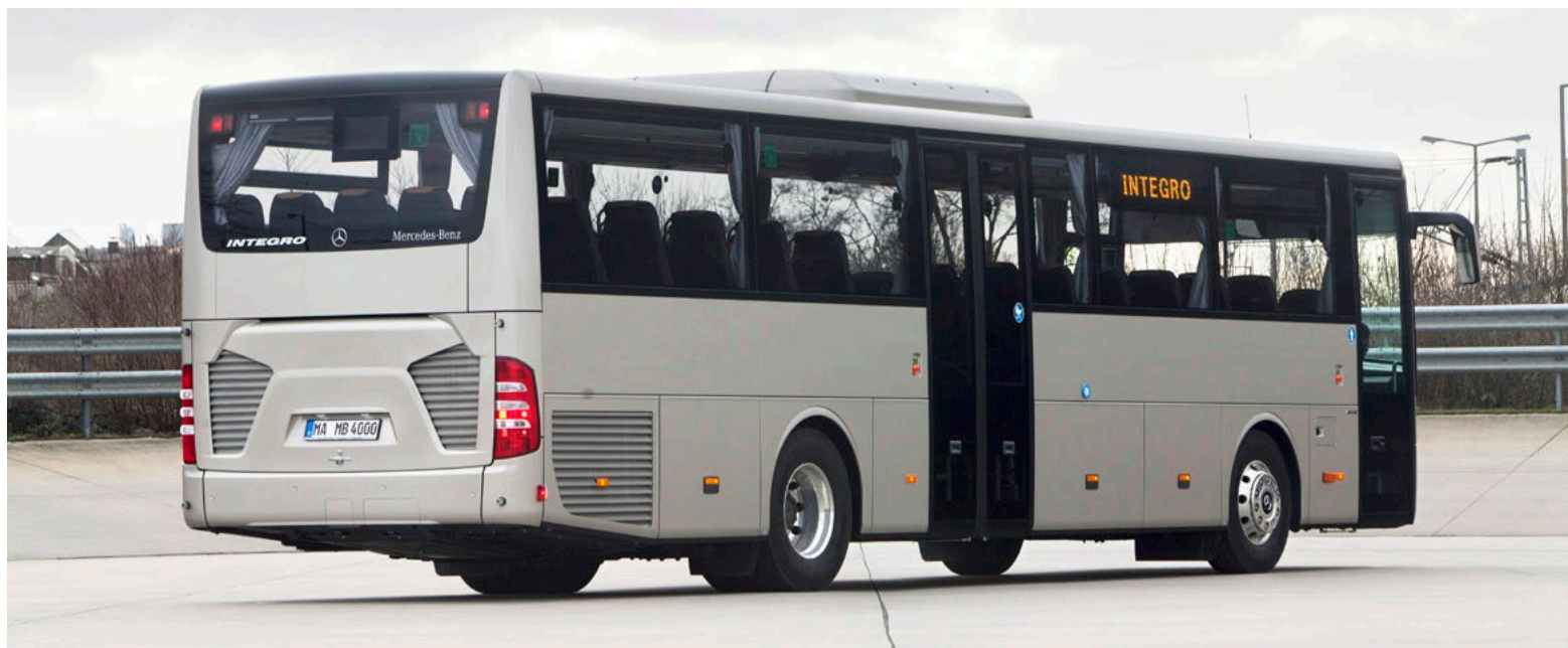
Im neu gestalteten Heck des Mercedes Integro steckt der Motor hinter einer Klappe aus Kunststoff mit Aluminium-Rahmen.
