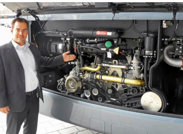
Platz gemacht: Rund um den schlanken stehenden Sechszylinder ist reichlich Luft.
