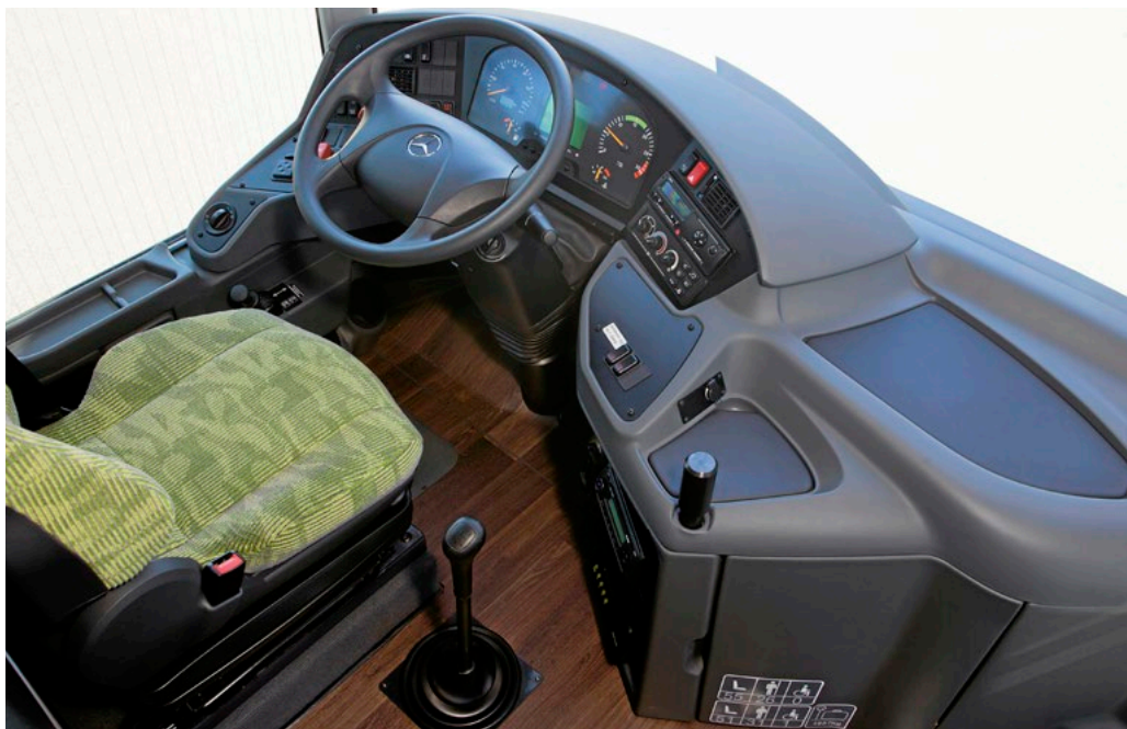
Das Cockpit des Intouro entspricht dem des Integro, man beachte den klassischen Schaltstock.
