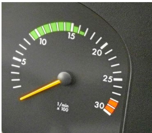
Kein Fehldruck: Die Maschine dreht bei Bedarf tatsächlich bis auf 2.800 Touren.
