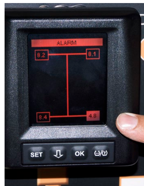
Display von Conti-Pressure-Check: Bei Druckverlust schlägt das Luftdruck-Kontrollsystem Alarm.
