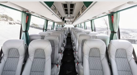
Neue Fahrgastsitze senken das Gewicht der Reisebusse um ungefähr 120 Kilogramm.
