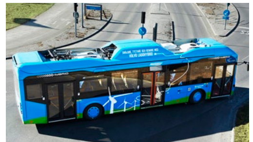
Das Dach des Plug-in-Hybriden zeigt eine Verwandtschaft zu Trolleybussen.
