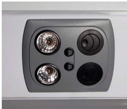
Funktionelle Servicesets, im Integro seitlich direkt an den Luftkanälen angebracht.
