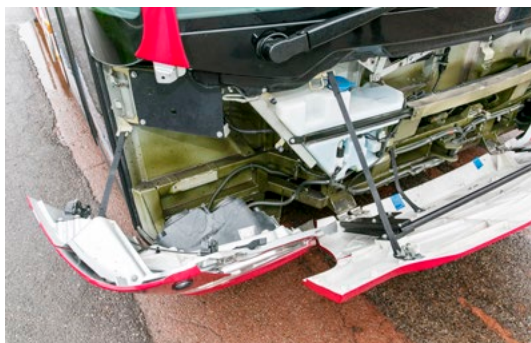
Ein Griff und die Front des Citaro entblättert sich für Kontrollen, Wartung, Lampenwechsel.
