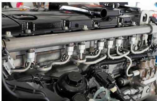
Neue Motoren mit Common-Rail-Einspritzung arbeiten sowohl sparsamer als auch leiser.
