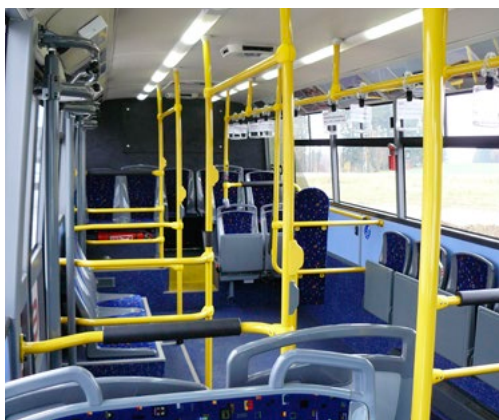
Niederflur-Innenraum mit zwei Reihen Logenplätzen über der Hinterachse des E-Busses.
