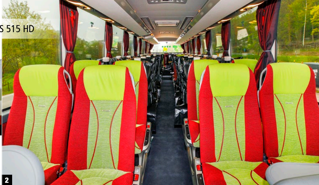
1 Viel Stehhöhe, hohe Gepäckablagen mit dezenten Halterungen, stoffbespannte Decke. 2 Geräumiger Fahrgastraum mit guter Sicht zur Seite dank schrägem Deckenluftkanal.
