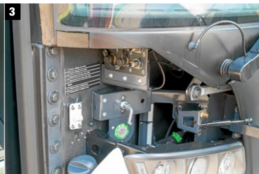
1 Dem schütteligen Fünfzylinder und seinen Nebenaggregaten gönnt Scania viel Platz. 2 Die Elektrik verbirgt sich unter der Decke, das spart Platz im Erdgeschoss. 3 Hauptschalter, Türöffner, Druckluftanschlüsse und Waschwasser finden sich vorne rechts.
