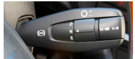
Die Bedienung des Powershift-Getriebes ist sehr einfach, Retarderfunktion wie gewohnt.
