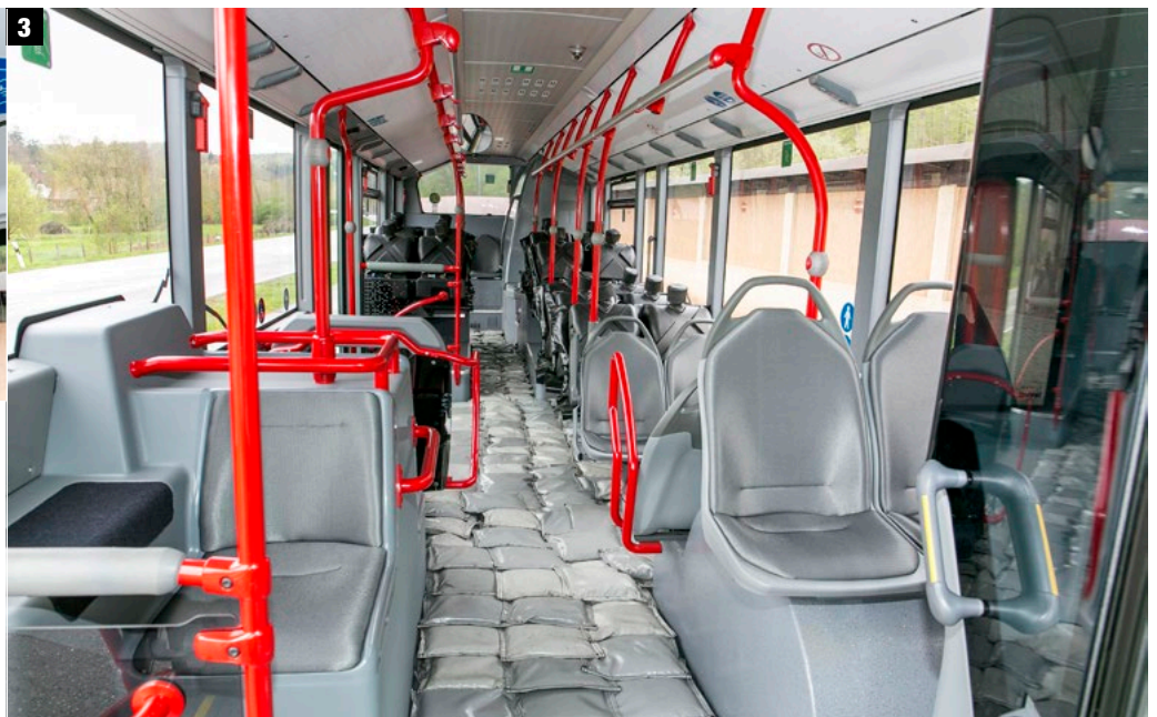
1 Auf Wunsch fährt der Citaro mit Nacht- und Ambientebeleuchtung vor. 2 Seitlich geneigte Stangen verbessern den Griff. 3 Der Fahrgastraum wirkt sachlich-freundlich – für den Test mit Sandsäcken beladen.
