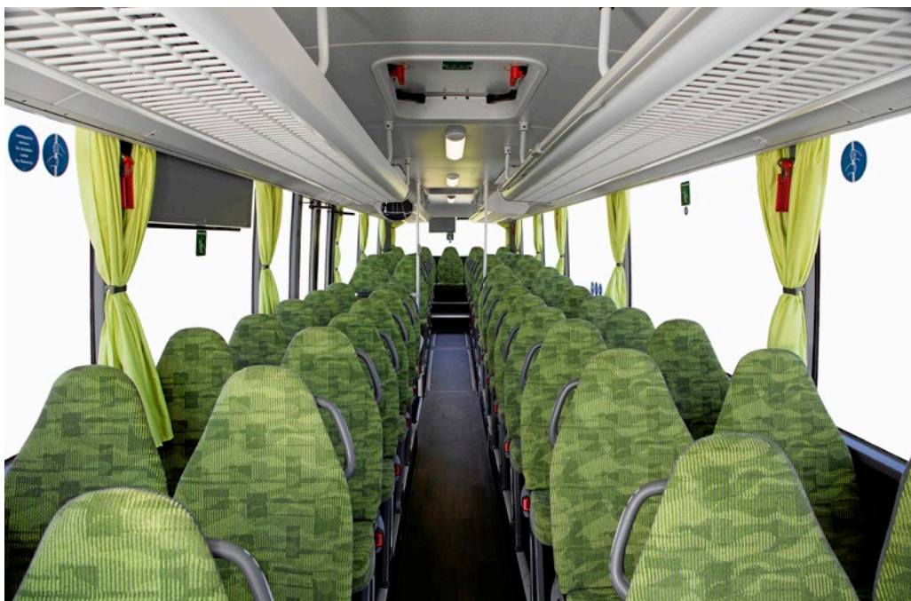
Der Fahrgastraum wirkt sachlich, Seriensitze mit kurzer Lehne und sehr straffer Polsterung der Sitzfläche. Eine einfache Reisebusbestuhlung und Vorhänge werten den Intouro auf.
