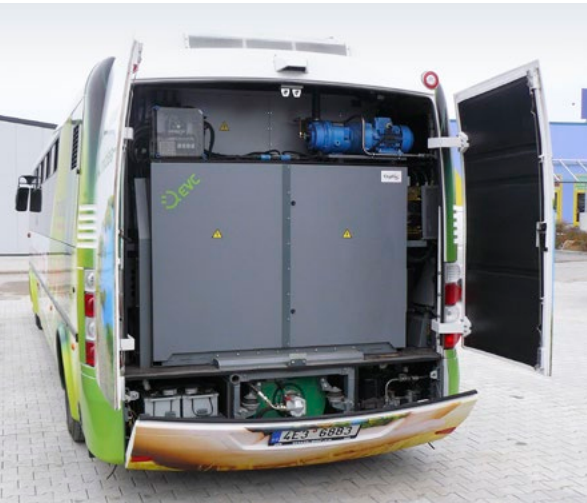
Die Antriebseinheit konzentriert sich auf das Heck, Batterien auf halber Höhe im Schrank.
