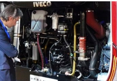
Quer- oder Längsmotor, beim Urbanway ist beides möglich.
