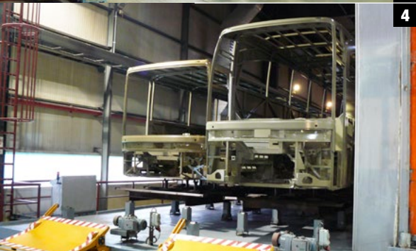
1 Der Dom von Istanbul: Zusammenbau der Rohbausegmente in einer Vorrichtung.
