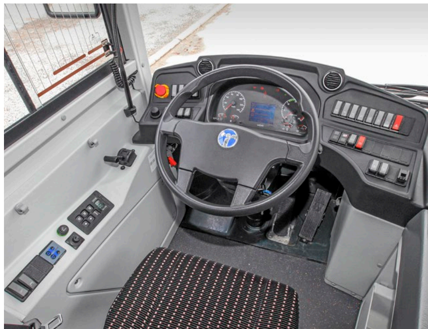
Das Cockpit ähnelt der VDV-Einteilung, Getriebetasten linker Hand.
