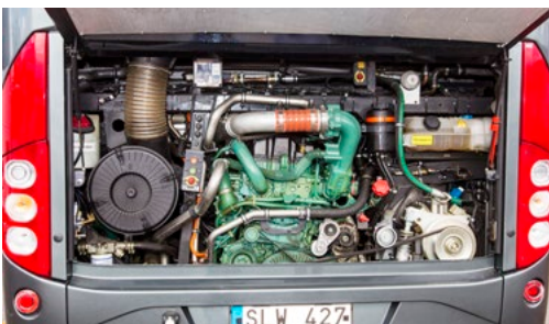
Ein wenig schräg eingebaut und temperamentvoll: neuer Diesel mit knapp elf Litern.
