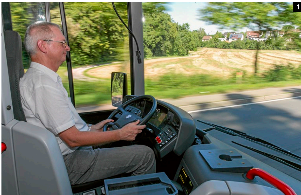
1 Das geräumige Cockpit lehnt sich an die VDV-Regeln an, Ablagen sind Mangelware. 2 Einfache Instrumentierung für den Alltag, tiefere Infos stecken im Display.
