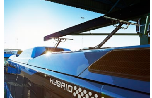
Stromabnehmer für eine frische Akku-Ladung in wenigen Minuten an der Endhaltestelle.
