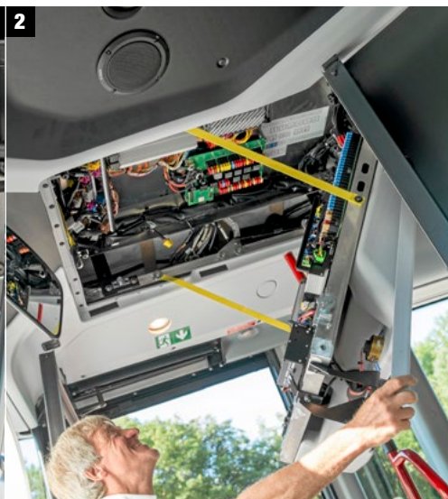
1 Dem schütteligen Fünfzylinder und seinen Nebenaggregaten gönnt Scania viel Platz. 2 Die Elektrik verbirgt sich unter der Decke, das spart Platz im Erdgeschoss. 3 Hauptschalter, Türöffner, Druckluftanschlüsse und Waschwasser finden sich vorne rechts.
