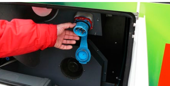
Die Batterien werden wahlweise mit 380 Volt oder per Schnellladung mit Strom gefüllt.
