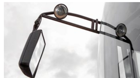
Dürre Spiegelarme, aber günstige Ersatzteile, kleiner Zusatzspiegel.
