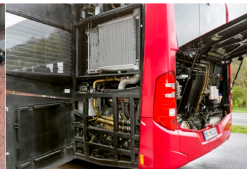
Der Motor duckt sich tief ins Heck, zahlreiche Klappen geben den Zugang fast rundum frei.
