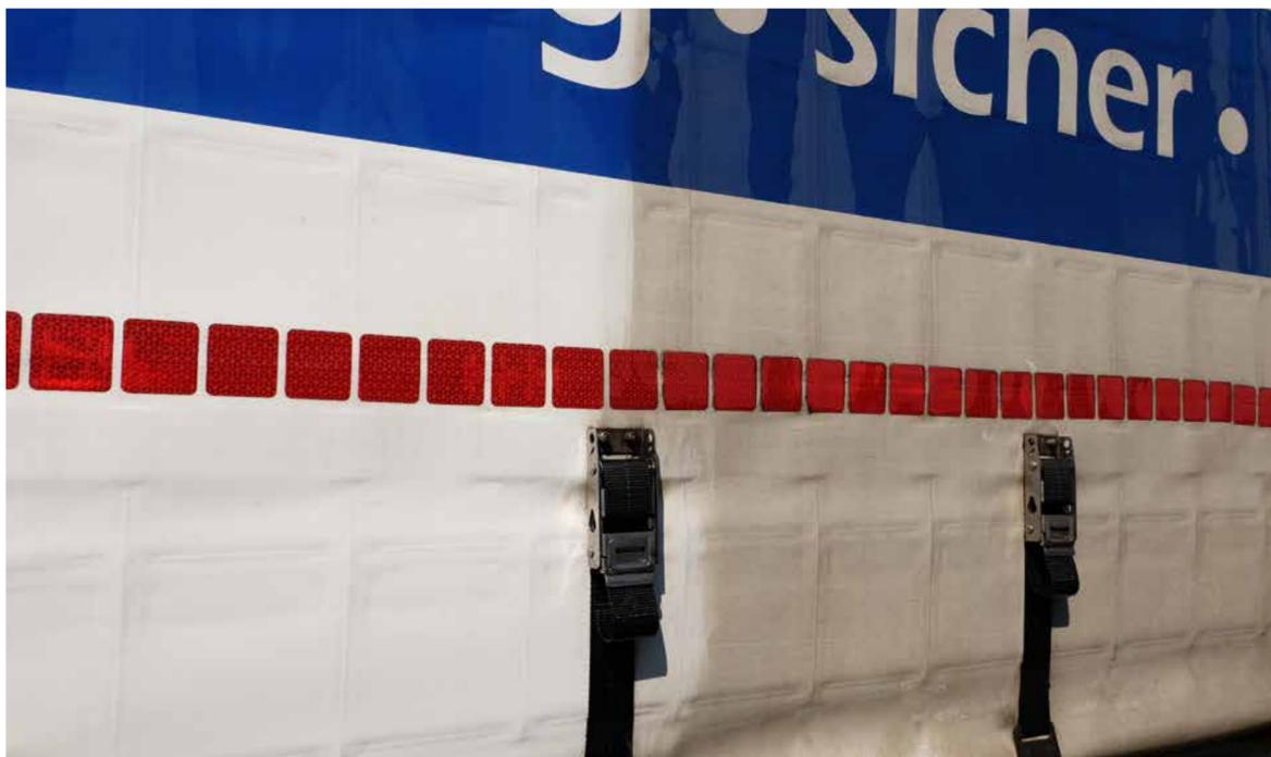
Je verschmutzter ein Reflektor ist, desto mangelhafter wird seine Funktion und das Fahrzeug ist im Dunkeln schlechter sichtbar.
