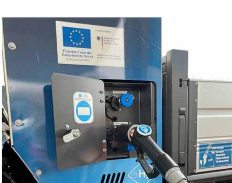
Aufgetankt wurde im Rahmen des Tests an einer öffentlichen Tankstelle. Zwei Doppeltanks fassen 14 Kilogramm Wasserstoff.
