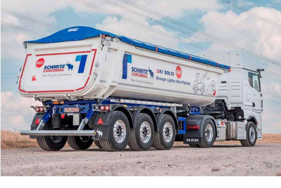
Auch bei den Kippnern setzt Schmitz Cargobull nicht mehr nur auf klassische Tugenden im Bereich von Stahl und Aluminium, sondern auch auf die Digitalisierung. Dies zeigte sich bei den SCB-Kippertagen in Gotha. Die Hardware gehört deswegen aber nicht zum alten Eisen. Im Gegenteil: Der neue Sattelkipper S.KI bietet je nach Ausführung gar bis zu 280 Kilo mehr Nutzlast. Die maximale Einsparung liefert demnach die neue Stahl-Rundmulde mit 24 Kubikmeter.
