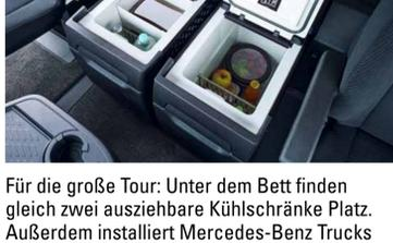
Für die große Tour: Unter dem Bett finden gleich zwei ausziehbare Kühlschranks Platz. Außerdem installiert Mercedes-Benz Trucks eine vollwertige 230-Volt-Steckdose.
