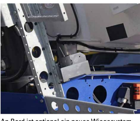
An Bord ist optional ein neues Wiegesystem. Dieses nutzt die Drücke in Luftfederung und Kippzylinder und übermittelt die Daten per WLAN-Antenne.
