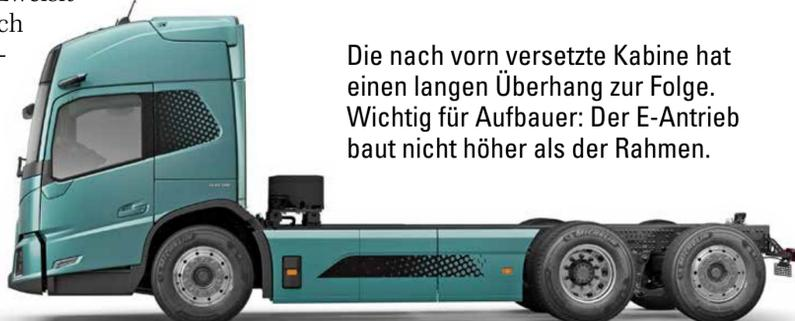
Die nach vorn versetzte Kabine hat einen langen Überhang zur Folge. Wichtig für Aufbauher: Der E-Antrieb baut nicht höher als der Rahmen.
