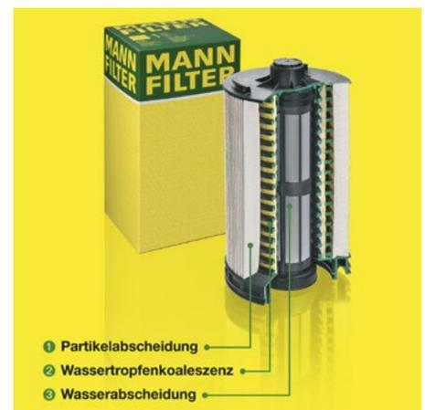
Wasser im Diesel ist in einigen Ländern der EU zunehmend ein Problem. Ein modernes System sammelt Tröpfchen, vergrößert sie und scheidet sie dann ab.
