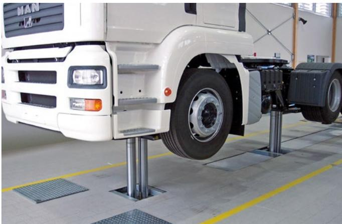
mobile elektro-hydraulisch betätigte Radgreiferanlage mit vier oder sechs Hebesäulen sowie 8.000 Kilogramm Tragkraft je Säule präsentiert. Auch hier sind die einzelnen Radgreifer über eine Funkverbindung miteinander verbunden und werden über Touchscreens an jeder Säule bedient. Die Rad-aufnahmen lassen sich an Reifendurchmesser von 600 bis 1.250 Millimeter anpassen. Damit eignet sich die Anlage für Transporter, Wohnmobile, leichte und schwere Lkw bis hin zu Landmaschinen gleichermaßen.
