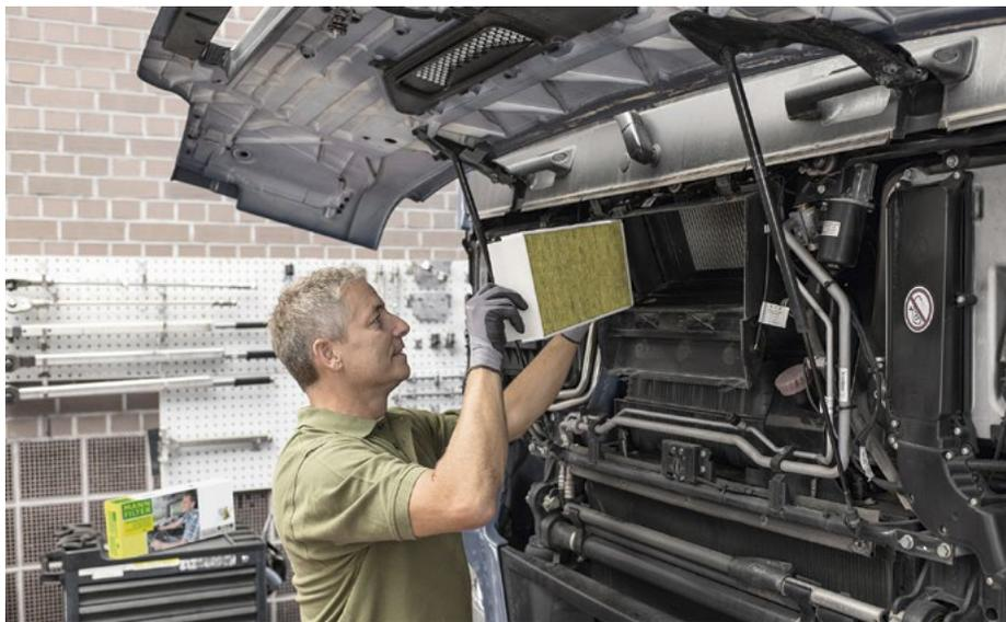
Innenraumfilter sollten gewechselt, aber nicht ausgeklopft werden, da die Schläge Strukturen zerstören können.
