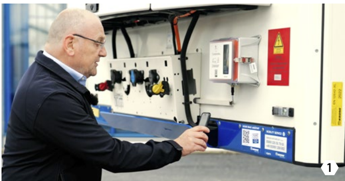
1 Jedes Krone-Fahrzeug ist digital mit dem entsprechenden Ersatzteilkatalog verknüpft. Diese Verknüpfung bildet ein QR-Code am Trailer ab.
