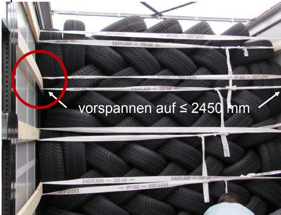
**Seitenrungen** diagonal, in Höhe von ca. 1.480 -2.775 mm, in den Zurrpunkten gemäß DIN EN 12640 abspannen.
