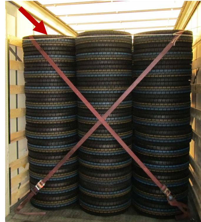
Diagonalgurtkreuz aus zwei Zurrgurten, die in Fahrtrichtung vorne links und rechts in den Zurrpunkten des Fahrzeugs eingehängt, nach hinten und über die jeweils äußere Säule geführt und dann in den Zurrpunkten des Fahrzeugs eingehängt werden.
