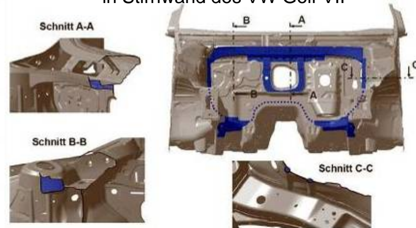
Beispiel: Geschlossener Torsionsring in Stirnwand des VW Golf VII
