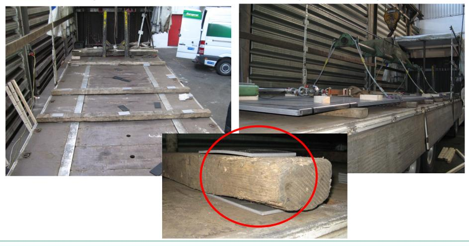
Beispiel: lange Tafelbleche – gummiertes Stahlhohl Profil als eine Alternative zum Holzbalken
